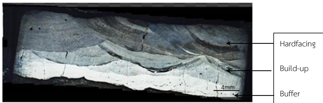
รูปที่ 3.9 ชั้นของชิ้นงานเชื่อม (B-U-2H) W โดยควบคุมอุณหภูมิชิ้นงานด้วยน้ำ
