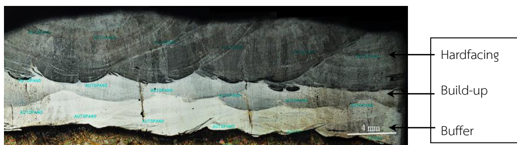
รูปที่ 3.6 ชั้นของชิ้นงานเชื่อม (B-U-H) A ในบรรยากาศปกติ
