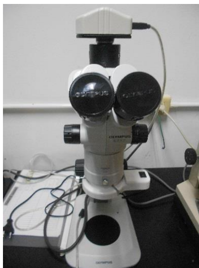
รูปที่ 2.3 กล้องจุลทรรศน์แบบใช้แสง มีกำลังขยายตั้งแต่ 4-28 เท่า
