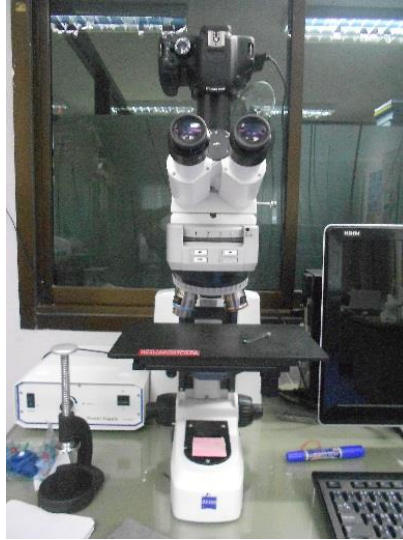
รูปที่ 2.4 กล้องจุลทรรศน์แบบใช้แสง มีกำลังขยายตั้งแต่ 25-500 เท่า
