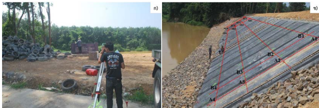
รูปที่ 5.28 การสำรวจหมุดติดตามการกัดเซาะด้วยกล้อง Total station ก) ถ่ายระดับจากจุดอ้างอิง BM1 ข) Grid ของตำแหน่งหมุดติดตามการกัดเซาะ
