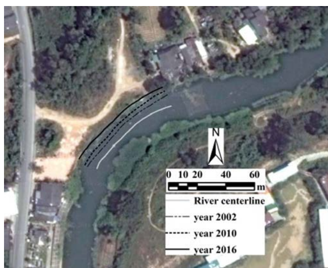
รูปที่ 4.3 ตัวอย่างภาพถ่ายทางอากาศแสดงการถดถอยของแนวตลิ่งคลองอุตะเกาตำแหน่ง UT6
