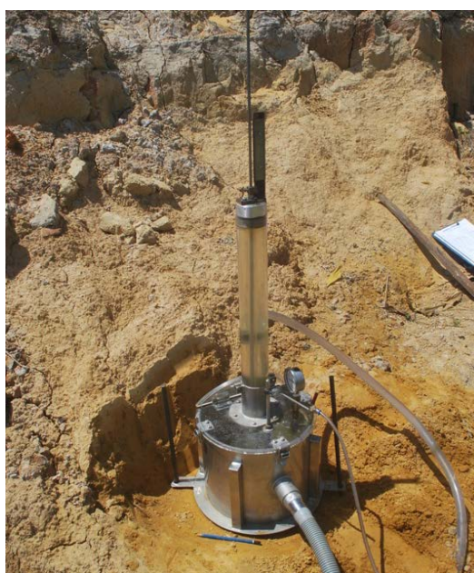
รูปที่ ข2 การติดตั้งเครื่องทดสอบการกัดเซาะตลิ่งในสนาม (Submerged jet device)
