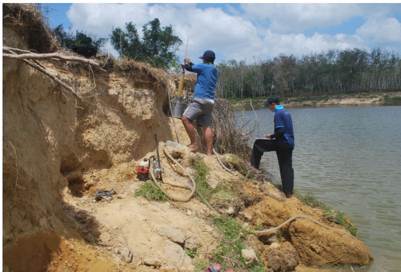
รูปที่ 3.4 การทดสอบ Submerged jet test บริเวณตลิ่งคลองอุตะเถา
