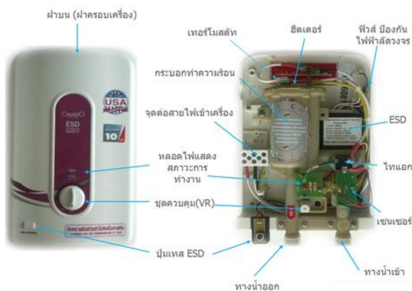
ภาพประกอบที่ 2-8 ส่วนประกอบของเครื่องทำน้ำร้อนแบบไฟฟ้า
