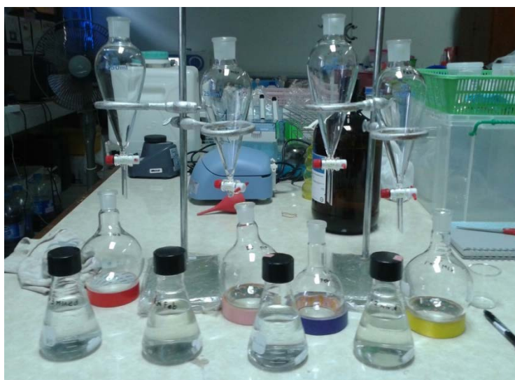
รูปที่ 2-10 อุปกรณ์การสกัดสาร DMA DEA และ DBA ด้วยเทคนิค liquid-liquid extraction
