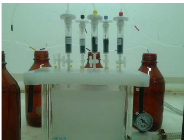
รูปที่ 2-9 อุปกรณ์ชุดสกัด Solid phase extraction (SPE)
