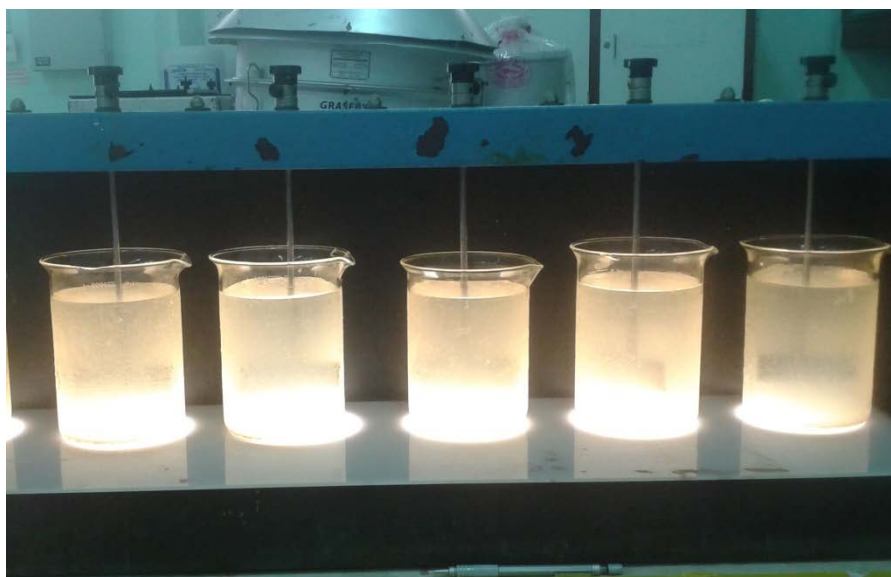
รูปที่ 2-11 การโคแอกกูเลชันด้วยวิธีจาร์เทสต์
