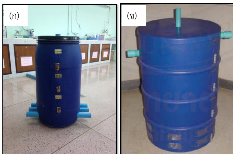
รูปที่ 3-22 เปรียบเทียบลักษณะการเติมอากาศของถังหมักพลาสติกขนาด 120 L
