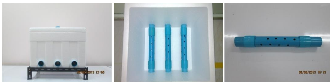
รูปที่ 3-7 ถังหมักที่มีอากาศเข้าและกระจายตัวในแนวนอน
