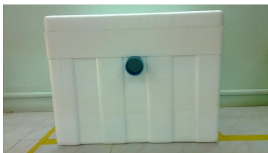
รูปที่ 2-17 ทางออกของอากาศรูปแบบที่ 2 ต้นแบบจริง
