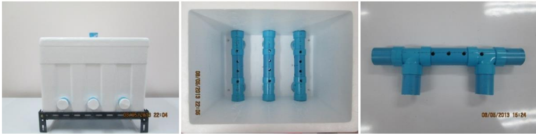
รูปที่ 2-11 ทางเข้าของอากาศรูปแบบที่ 4 ต้นแบบจริง
