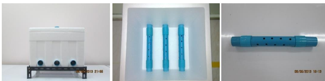
รูปที่ 2-7 ทางเข้าของอากาศรูปแบบที่ 2 ต้นแบบจริง
