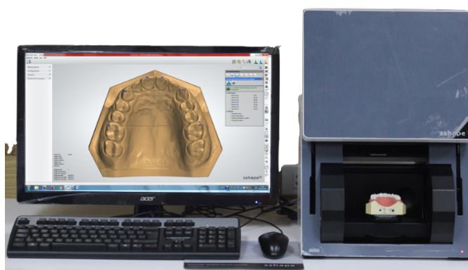
รูปที่ 8 การสแกนแบบจำลองฝึกปฏิบัติทางทันตกรรมด้วยเครื่อง 3Shape R700™ (3-Shape™, Copenhagen, Denmark)
