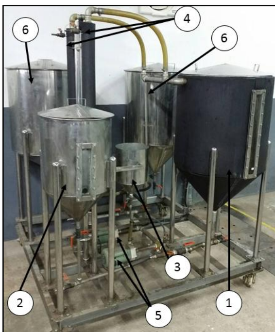
รูปที่ 4 ชุดปฏิกรณ์ท่อผสมสติดแบบหมุนวนในการทดลองการลดกรดไขมันอิสระในน้ำมันปาล์มดิบหีบรวมชนิดกรดไขมันอิสระสูง
