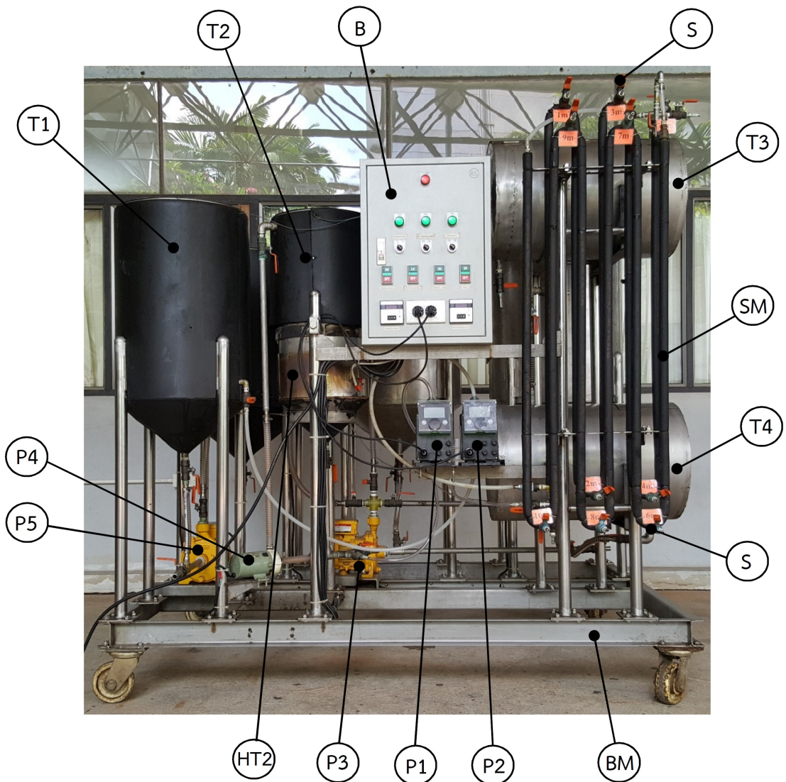
รูปที่ 4.1 เครื่องผลิตเอทิลเอสเทอร์แบบต่อเนื่องจากน้ำมันปาล์มบริสุทธิ์ด้วยท่อผสมแบบสถิต พร้อมกับระบบทำความสะอาดไบโอดีเซลแบบกะ (ด้านหน้า)
