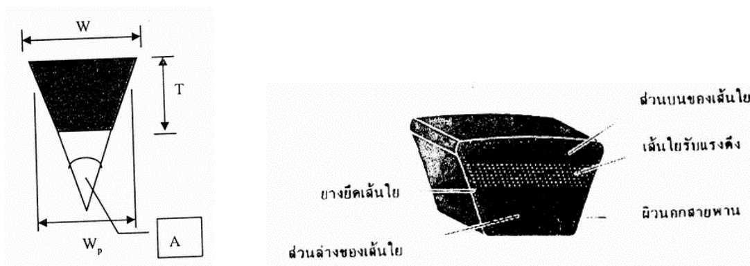
รูปที่ 2.1 แสดงการบอกขนาดและส่วนประกอบของเส้นใยต่างๆ ในสายพานลิ่มมาตรฐาน [4]
