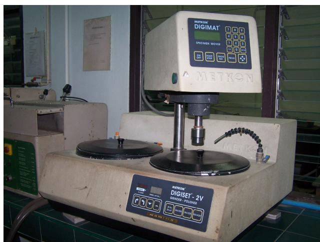
รูปที่ 1.2 เครื่องขัดผิวชิ้นงานชนิดจานคู่อัตโนมัติ METKON DIGISET 2V and DIGIMAT ครุภัณฑ์ปี 2545
