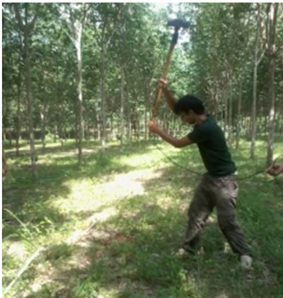
รูปที่ 3.9 ภาพแสดงการเก็บข้อมูลภาคสนามด้วยวิธี MASW
