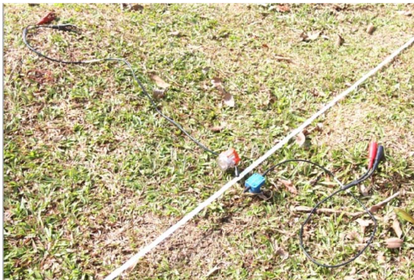
รูปที่ 3.2 อุปกรณ์และเครื่องมือที่ใช้ในการเก็บข้อมูลคลื่นไหวสะเทือน a) Geometric SmartSeis seismograph, b) vertical geophone (ขวา) และ horizontal geophone (ซ้าย)
