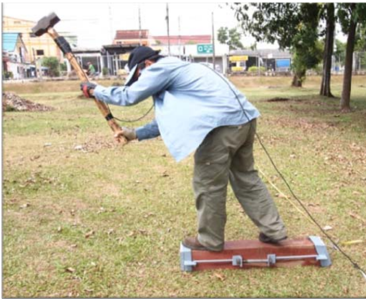
รูปที่ 3.4 แสดงการให้กำเนิดคลื่นสำหรับวิธี (a) MASW และ (b) คลื่นไหวสะเทือนแบบหักเหของคลื่นเฉือน
