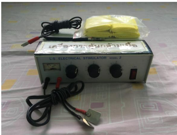
ภาพที่ 4.7 เครื่องกระตุ้นกล้ามเนื้อด้วยไฟฟ้า (ES)
