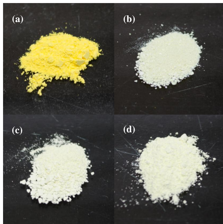
รูปที่ 4.4 ภาพถ่ายวัสดุผสมสังเคราะห์ด้วยวิธีตกตะกอนร่วมที่สัดส่วนทั้งสแตนไดรออกไซด์-โมลิบดีนัมไดรออกไซด์ที่ต่างกันไป คือ 0, 20, 40 และ 50 เปอร์เซ็นต์โดยน้ำหนัก ในตัวอย่าง (a) W, (b) 8WM (c) 6WM และ(d) WM ตามลำดับ
