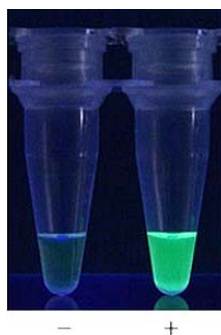
รูปที่ 8 การตรวจสอบผลการเพิ่มปริมาณของ DNA เป้าหมายจากเทคนิค LAMP เมื่อตรวจวัดโดยการใช้สีฟลูออเรสเซนซ์; (-) ผลลบ; (+) ผลบวก (Eiken Chemical Co., Ltd., Tokyo, Japan)
