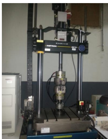
ภาพประกอบที่ 3-8 เครื่องทดสอบความแข็งของเม็ดถ่าน
