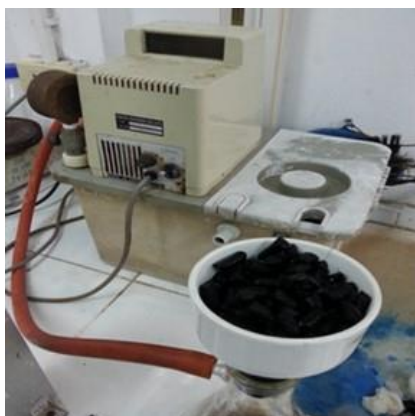
ภาพประกอบที่ 3-10 แสดงการกรองเอาเม็ดถ่านออกจากสารละลายโพแทสเซียมไฮดรอกไซด์
