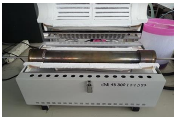
ภาพประกอบที่ 3-12 เตาเผาแบบท่อสำหรับการเผากระดูกถ่านเพื่อผลิตถ่านกัมมันต์
