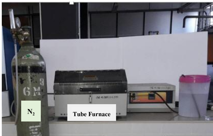
ภาพประกอบที่ 3-13 แสดงกระบวนการเผากระตุ้นถ่าน
