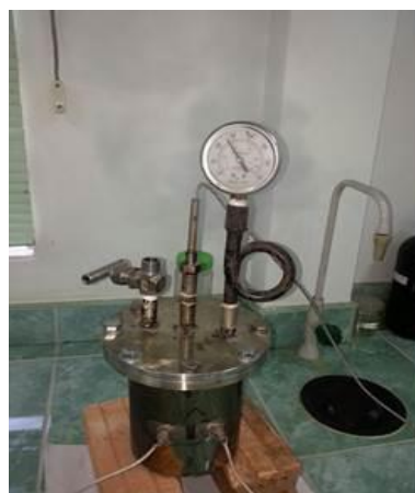
ภาพประกอบที่ 3-18 ระบบพื้นฟูแบบเบตซ์สำหรับกระตุ้นถ่านกัมมันต์ที่ใช้งานแล้ว
