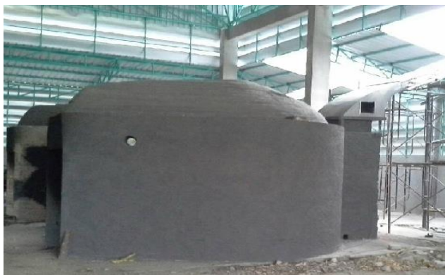
ภาพประกอบที่ 2-3 เตาเผาอิวาเตะสำหรับผลิตน้ำส้มควันไม้
