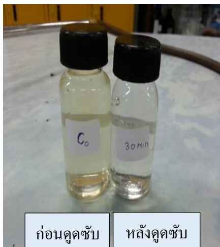
ภาพประกอบที่ 4-21 ลักษณะของน้ำก่อนและหลังการดูดซับสารละลายเหล็กที่ความเข้มข้นเริ่มต้นของเหล็ก 5 มิลลิกรัมต่อลิตร
