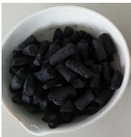
ภาพประกอบที่ 3-14 ถ่านกัมมันต์เม็ดที่ผลิตได้จากการกระตุ้นด้วยโพแทสเซียมไฮดรอกไซด์
