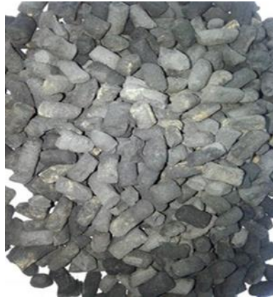
ภาพประกอบที่ 3-19 ถ่านกัมมันต์หลังจากการคืนสภาพแล้ว
