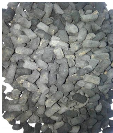
ภาพประกอบที่ 4-25 ถ่านกัมมันต์เม็ดหลังจากฟื้นฟูสภาพแล้ว
