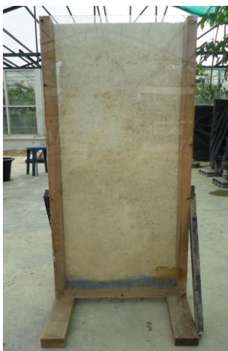
ภาพที่ 1 ไรโซบ็อกซ์ที่ใช้ปลูกถัวยางพาราเพื่อศึกษาการเจริญเติบโตของระบบราก
