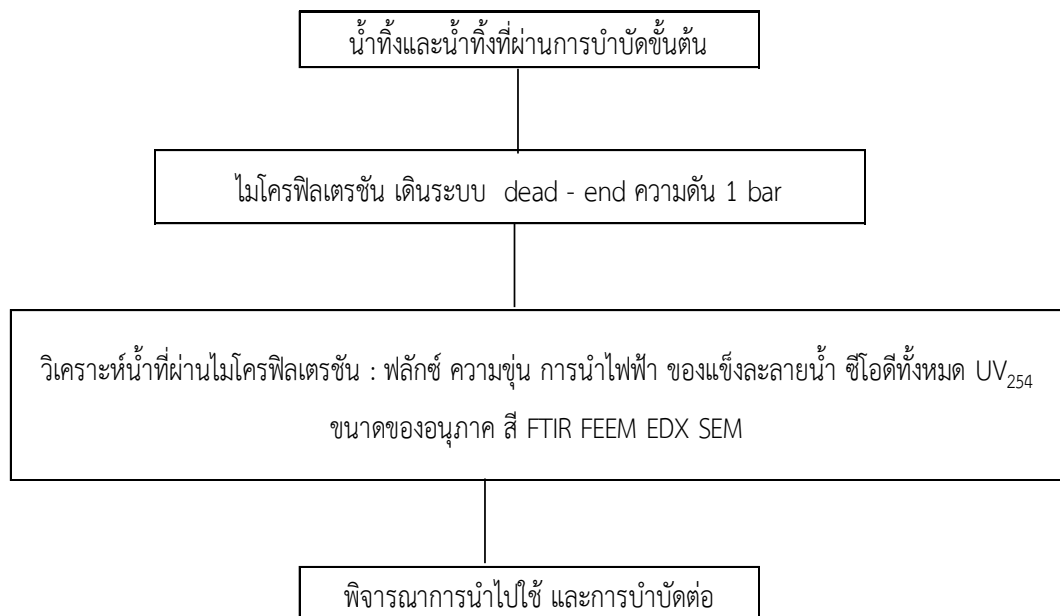
รูปที่ 3.8 ขั้นตอนการบำบัดน้ำทิ้งอุตสาหกรรมสกักน้ำมันปาล์มด้วยเมมเบรน
