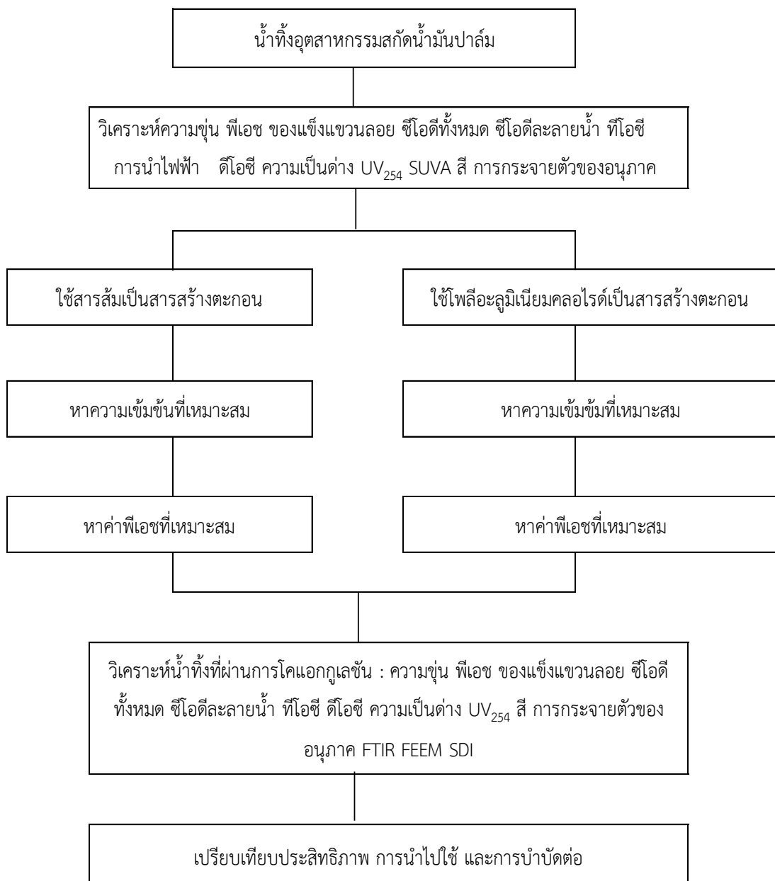
รูปที่ 3.3 ขั้นตอนการบำบัดน้ำทิ้งอุตสาหกรรมสกัดน้ำมันปาล์มด้วยกระบวนการโคแอกกูเลชัน
