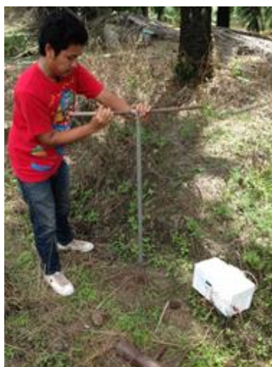
รูปที่ 3.4 การเจาะเก็บดินแบบ disturbed sample
