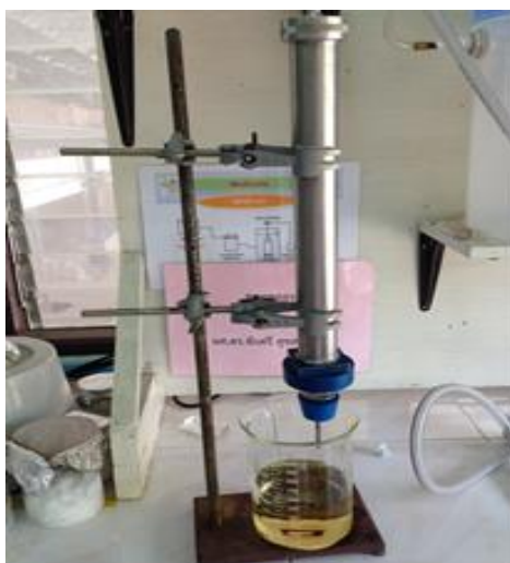
รูปที่ 3.7 อุปกรณ์ทดลองเมมเบรนแบบ dead – end
