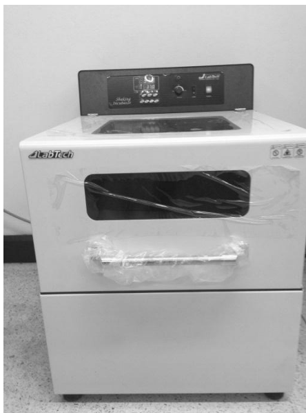
ภาพประกอบที่ 3-2 ตู้ควบคุมอุณหภูมิแบบเขย่า (Shaking incubator)
