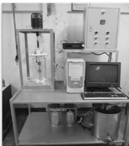
ภาพประกอบที่ 3-9 ถังปฏิกรณ์ขนาด 5 ลิตร (สร้างจากงานวิจัย ผศ. ดร. สินีนาฏ จงคง ทุน งบประมาณแผ่นดินปี 2554)
