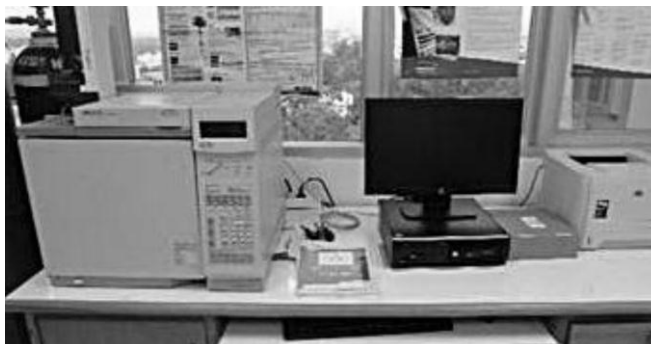
ภาพประกอบที่ 3-4 Gas chromatography (GC) รุ่น 6890 flame ionization ยี่ห้อ Agilent
