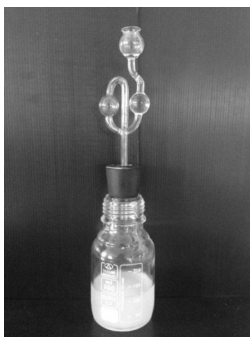
ภาพประกอบที่ 3-6 ชุดขวดหมักขนาด 250 มิลลิลิตร
