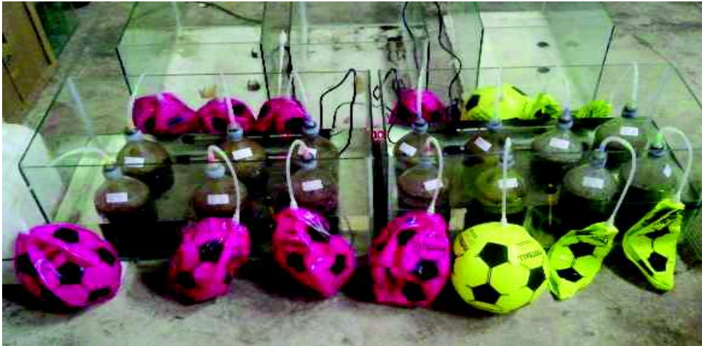
ภาพประกอบที่ 3-5 ลักษณะชุดอุปกรณ์ระบบแบบกะและการควบคุมอุณหภูมิที่ 35 \pm 1^{\circ}\text{C} และ 55 \pm 1^{\circ}\text{C}
