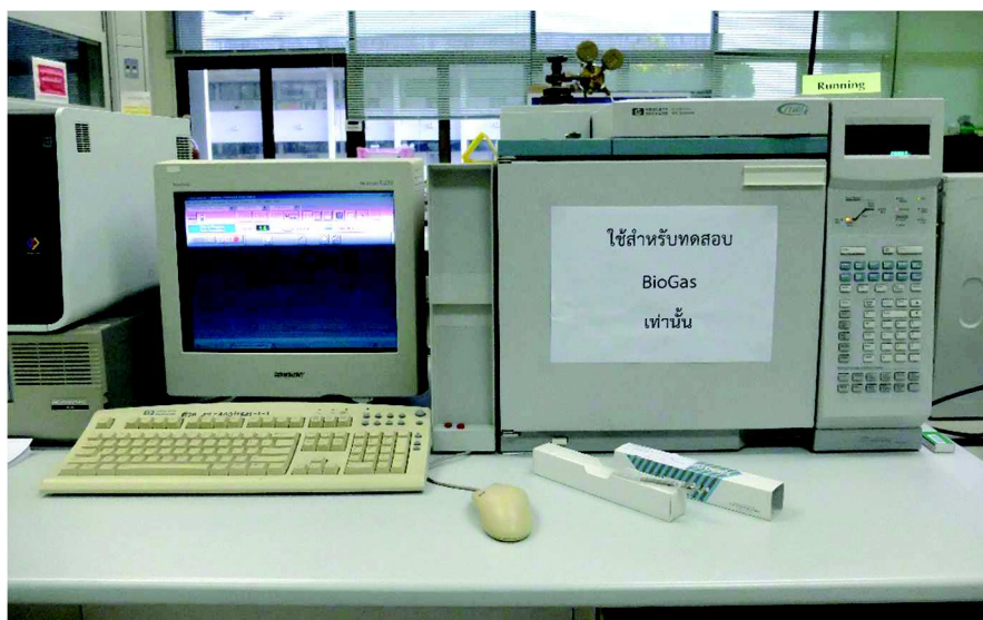
ภาพประกอบที่ 3-8 เครื่องวิเคราะห์ห้องค์ประกอบก๊าซชีวภาพที่ใช้ในการทดลอง
