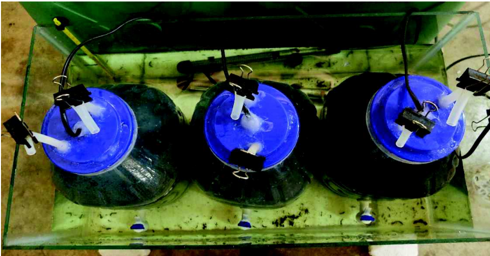
ภาพประกอบที่ 3-6 ลักษณะชุดอุปกรณ์และการเดินระบบในการหมักแบบกึ่งต่อเนื่อง
