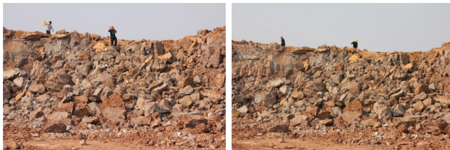
รูปที่ ฉ-3 ผลการระเบิดวันที่ 19 เดือนมกราคม พ.ศ.2557 ที่ 12 มิลลิวินาที
