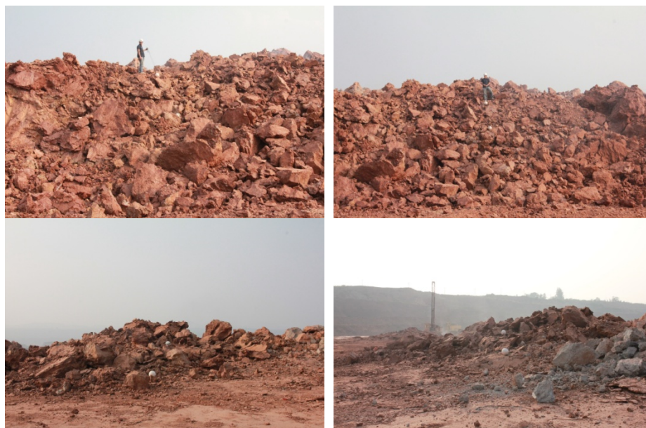
รูปที่ จ-5 ผลการระเบิดวันที่ 12 เดือนธันวาคม พ.ศ.2556 แบบ 1.7 เมตร : 2.3 เมตร
