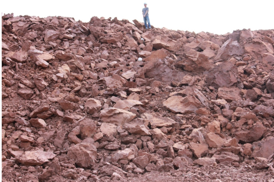
รูปที่ 3.3 ขนาดของดินที่ได้จากการระเบิดของการระเบิด โดยใช้กรวยอุดระเบิดแบบธรรมดา
