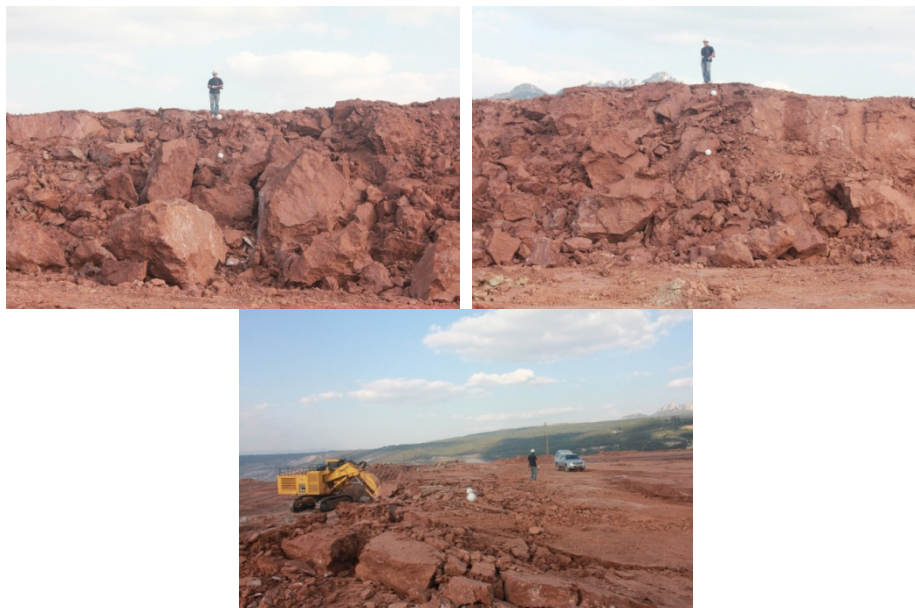
รูปที่ ง-7 ผลการระเบิดวันที่ 20 เดือนธันวาคม พ.ศ.2556 air deck 15%
