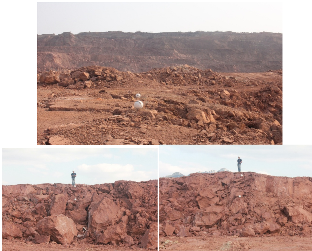
รูปที่ 3.11ขนาดของดินที่ได้จากการระเบิดโดยใช้เทคนิค Air-deck 15%
