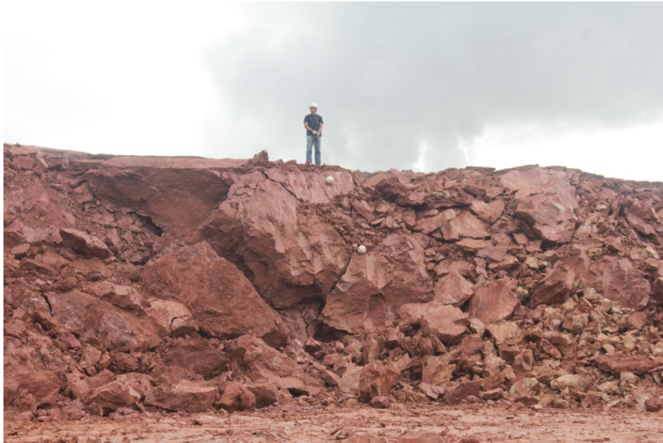
รูปที่ 3.4 ขนาดการแตกของดินที่ได้จากการระเบิดของการระเบิดแบบที่เหมืองแม่เมาะใช้
