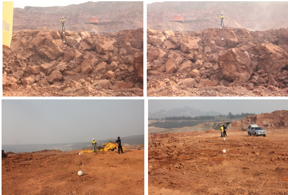
รูปที่ ง-5 ผลการระเบิดวันที่ 24 เดือนกุมภาพันธ์ พ.ศ.2557 air deck 12.5%
