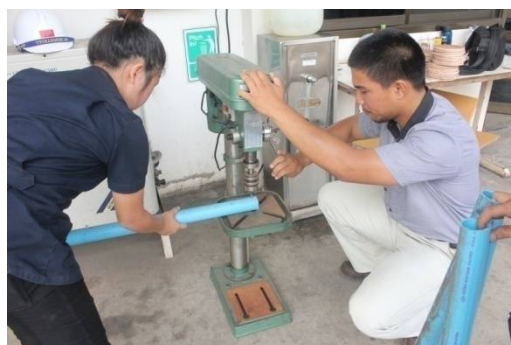
รูปที่ 2.22 การจัดเตรียมอุปกรณ์สำหรับใช้เป็นช่องว่างในการระเบิด
