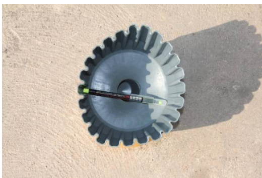
รูปที่ 2.9 กรวยอุดระเบิดขนาด 178 มิลลิเมตรที่ใช้ในการศึกษา
