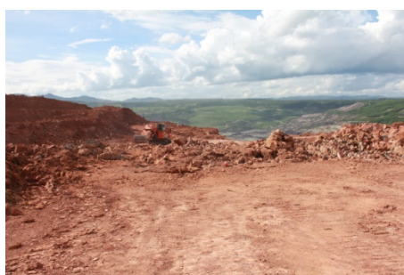
รูปที่ จ-2 ผลการระเบิดวันที่ 19 เดือนสิงหาคม พ.ศ.2556 แบบ 1.5 เมตร : 2.5 เมตร
