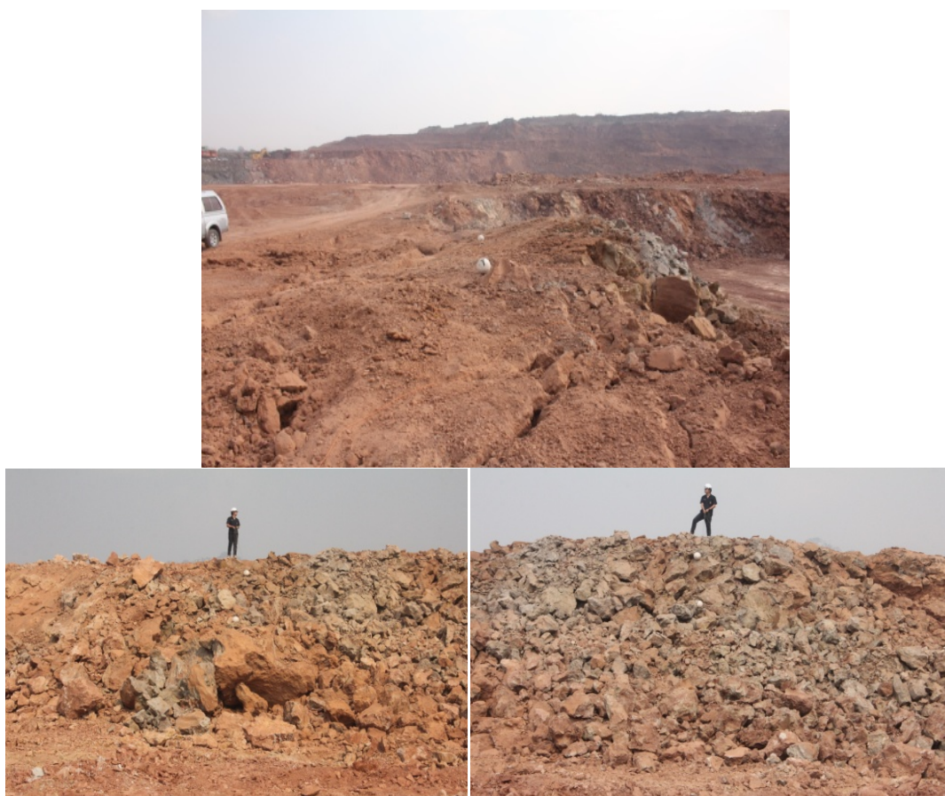
รูปที่ 3.9 ขนาดของดินจากการระเบิดโดยใช้เทคนิค Air-deck 10%
