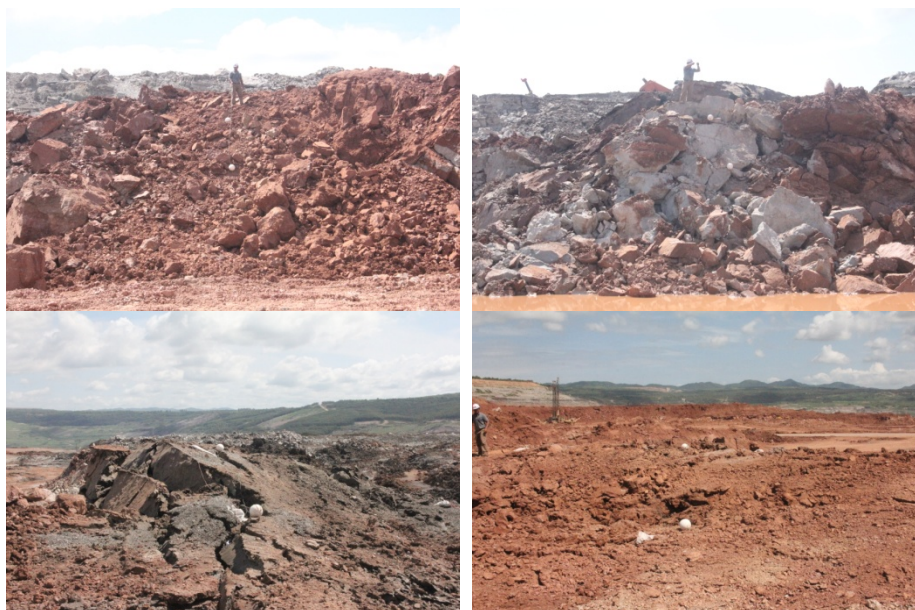
รูปที่ ฉ-1 ผลการระเบิดวันที่ 4 เดือนกรกฎาคม พ.ศ.2557 ที่ 8 มิลลิวินาที
