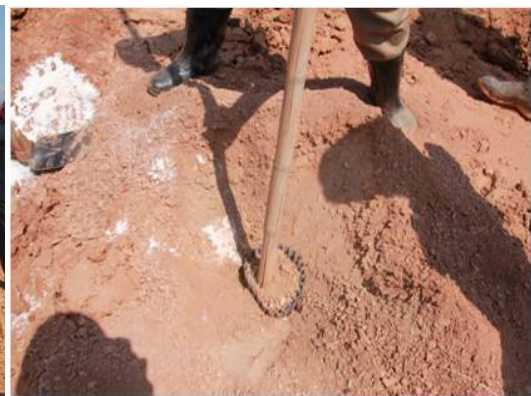
รูปที่ 2.13 การเตรียมการทดลองสำหรับการระเบิด โดยใช้กรวยอุดรูระเบิด
