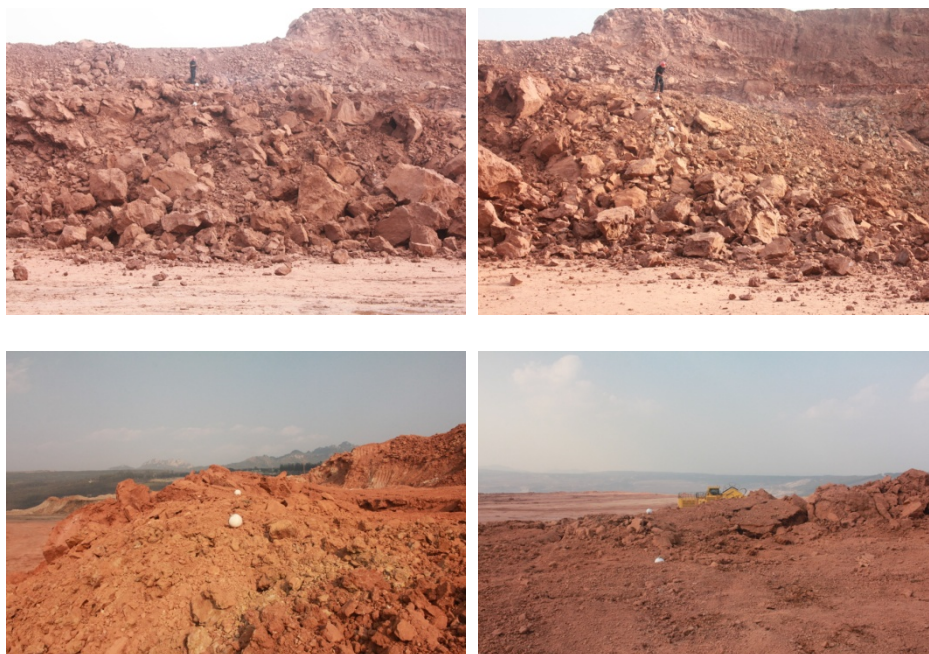
รูปที่ ค-5 ผลการระเบิดวันที่ 29 เดือนมกราคม พ.ศ.2557 แบบเพิ่มปริมาณวัสดุระเบิด
