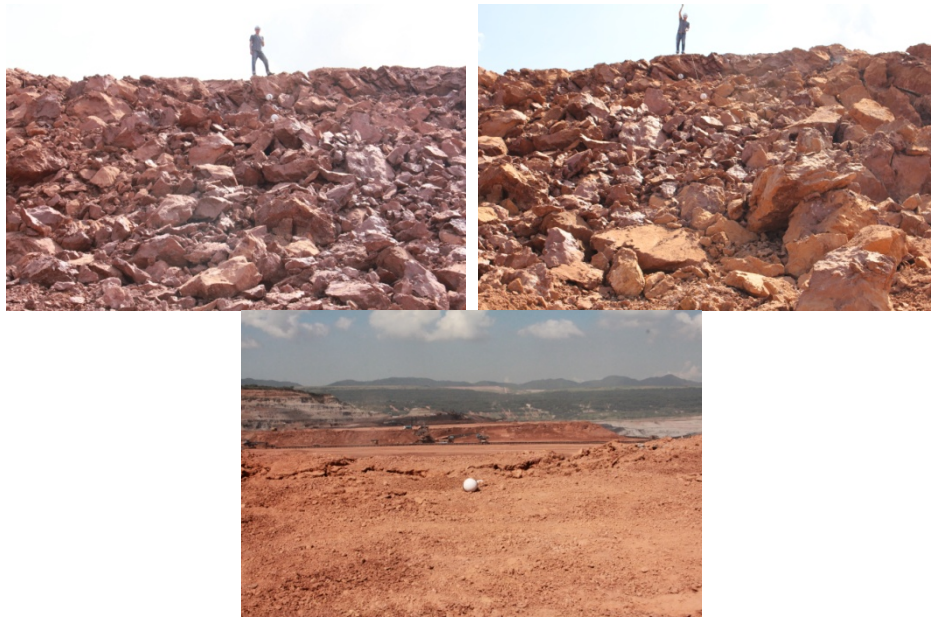
รูปที่ ค-1 ผลการระเบิดวันที่ 12 เดือนพฤศจิกายน พ.ศ.2556 แบบธรรมดา
