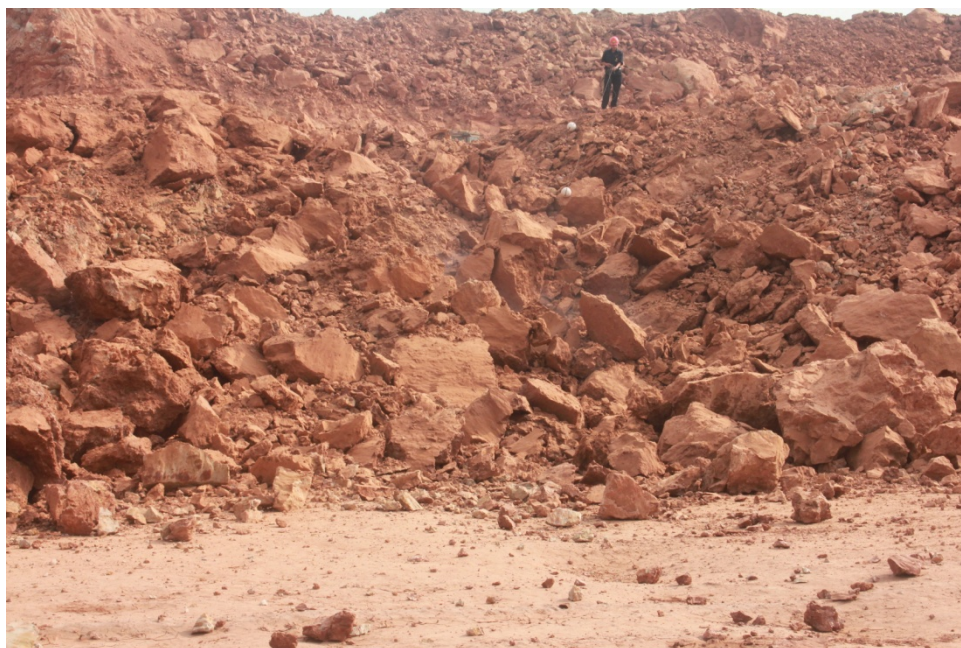
รูปที่ 3.6 ขนาดของดินที่ได้จากการระเบิด โดยใช้กรวยอุดระเบิดแบบเพิ่ม Explosive factor
