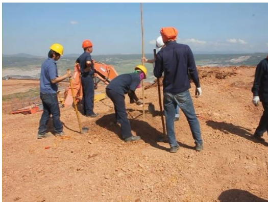
รูปที่ 2.13 การเตรียมการทดลองสำหรับการระเบิด โดยใช้กรวยอุดรูระเบิด
