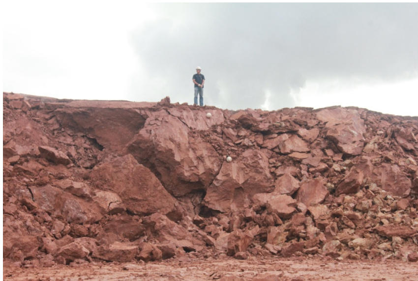
รูปที่ 3.1 ขนาดการแตกของดินที่ได้จากการระเบิดแบบที่เหมืองแม่เมาะใช้ในปัจจุบัน
