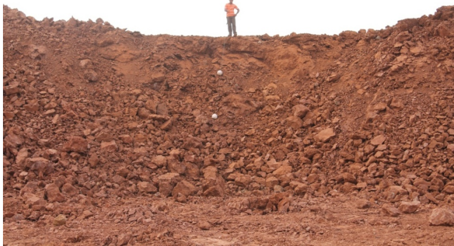
รูปที่ 3.13ขนาดของดินและการแตกที่หน้าออกของลูกบอลสเกลโดยใช้เทคนิคการแบ่งบรรจุวัตถุระเบิดออกเป็นช่วงกรณีที่ 1 แบบ 1.5 เมตร:2.5 เมตร
