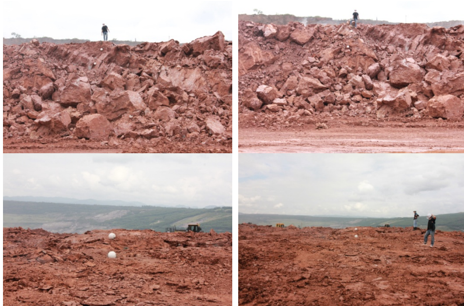
รูปที่ ค-3 ผลการระเบิดวันที่ 19 เดือนพฤศจิกายน พ.ศ.2556 แบบขยายระยะห่างระหว่าง รูเจาะ
