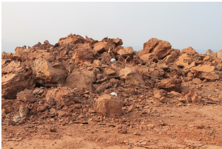
รูปที่ 3.14ขนาดของดินจากการระเบิดโดยใช้เทคนิคการแบ่งบรรจุวัตถุระเบิดออกเป็นช่วงกรณีที่ 2 แบบ 1.7 เมตร:2.3 เมตร
