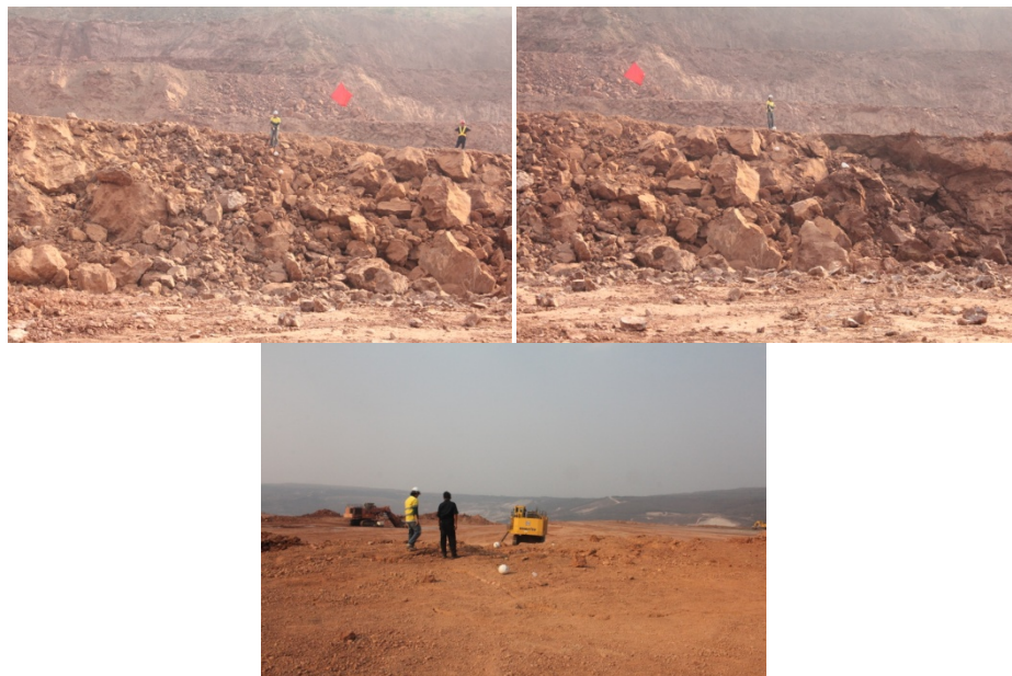
รูปที่ ง-2 ผลการระเบิดวันที่ 26 เดือนกุมภาพันธ์ พ.ศ.2557 air deck 10%
