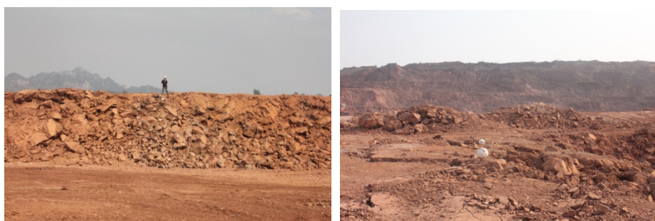
รูปที่ ง-8 ผลการระเบิดวันที่ 24 เดือนมีนาคม พ.ศ.2557 air deck 15%
