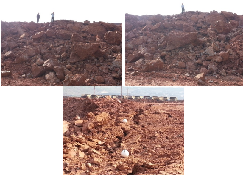
รูปที่ ฅ-5 ผลการระเบิดวันที่ 10 เดือนตุลาคม พ.ศ.2557 ที่ 15 มิลลิวินาที
