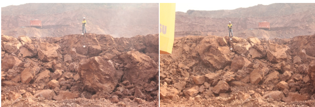
รูปที่ 3.10 ขนาดของดินที่ได้จากการระเบิดโดยเทคนิค Air-deck 12.5%
