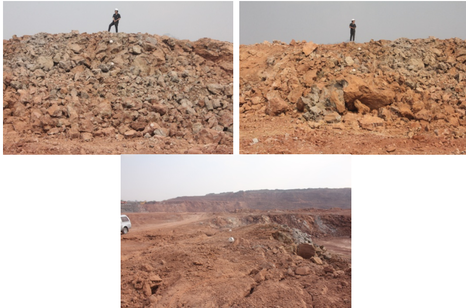
รูปที่ ง-3 ผลการระเบิดวันที่ 28 เดือนมีนาคม พ.ศ.2556 air deck 10%
