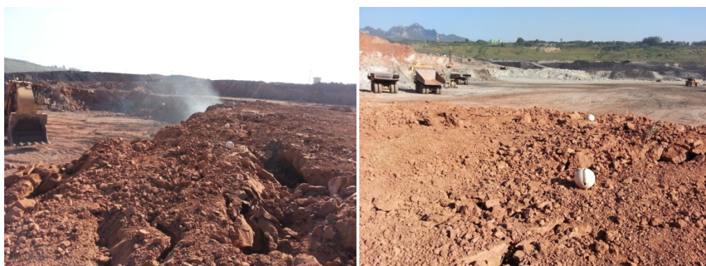
รูปที่ 3.18 ผลการระเบิดโดยใช้หลักการ Waveform interference ถ่วงจังหวะที่ 15 มิลลิวินาที
