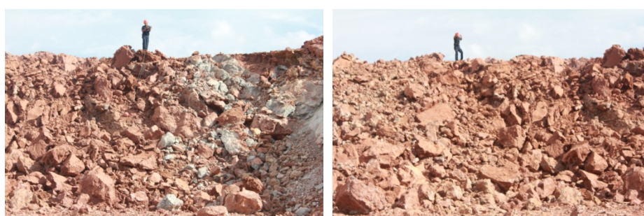
รูปที่ จ-1 ผลการระเบิดวันที่ 16 เดือนสิงหาคม พ.ศ.2556 แบบ 1.5 เมตร : 2.5 เมตร
