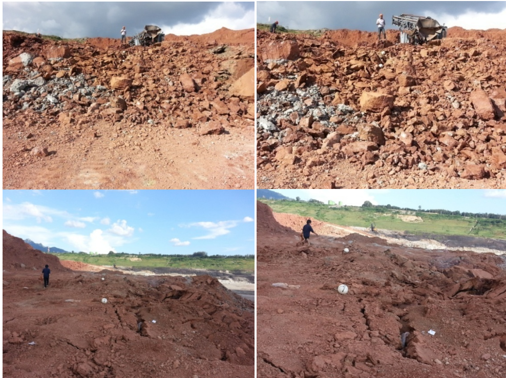
รูปที่ 3.19 ผลการระเบิดโดยใช้หลักการ Waveform interference ถ่วงจังหวะที่ 18 มิลลิวินาที
