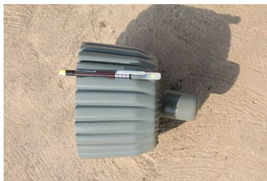
รูปที่ 2.9 กรวยอุดระเบิดขนาด 178 มิลลิเมตรที่ใช้ในการศึกษา
