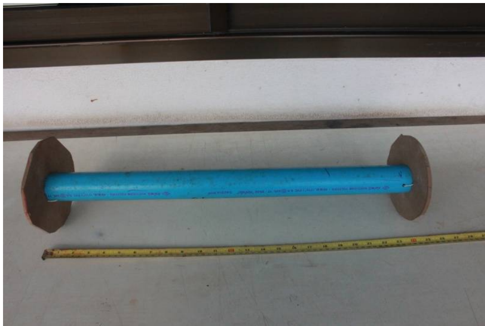
รูปที่ 2.15 ชุดอุปกรณ์สำหรับใช้เป็นช่องว่างในการทำ air-deck ที่ 10 %
