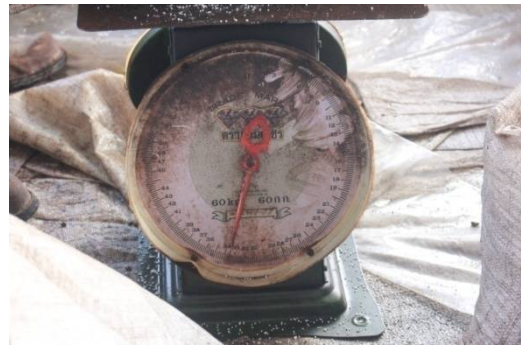
รูปที่ 2.20 การชั่งน้ำหนัก ANFO สำหรับการทดลอง
