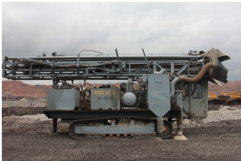
รูปที่ ก-1 รถเจาะสำหรับใช้ในการทดลอง REED SK 40
