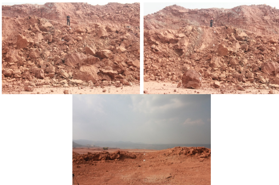
รูปที่ ค-6 ผลการระเบิดวันที่ 30 เดือนมกราคม พ.ศ.2557 แบบเพิ่มปริมาณวัสดุระเบิด
