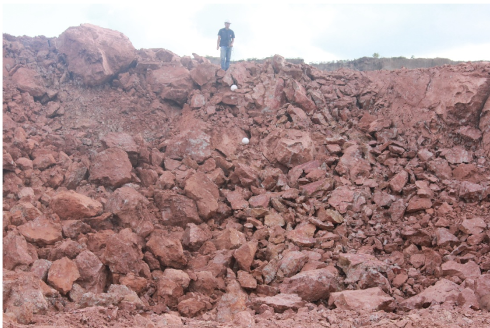
รูปที่ 3.5 ขนาดของดินจากการระเบิด โดยใช้กรวยอุดระเบิดแบบลด Explosive factor
