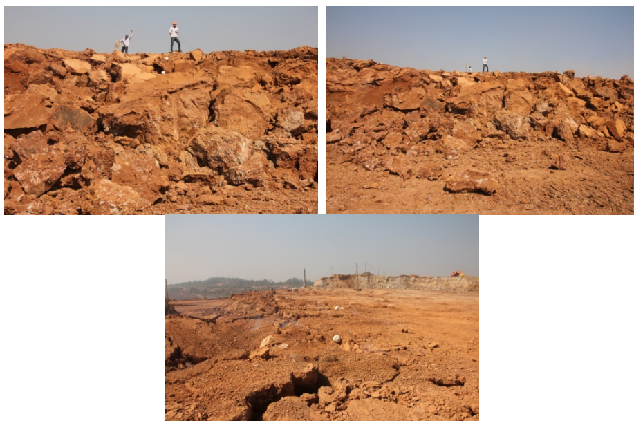
รูปที่ ฉ-4 ผลการระเบิดวันที่ 27 เดือนมกราคม พ.ศ.2557 ที่ 12 มิลลิวินาที
