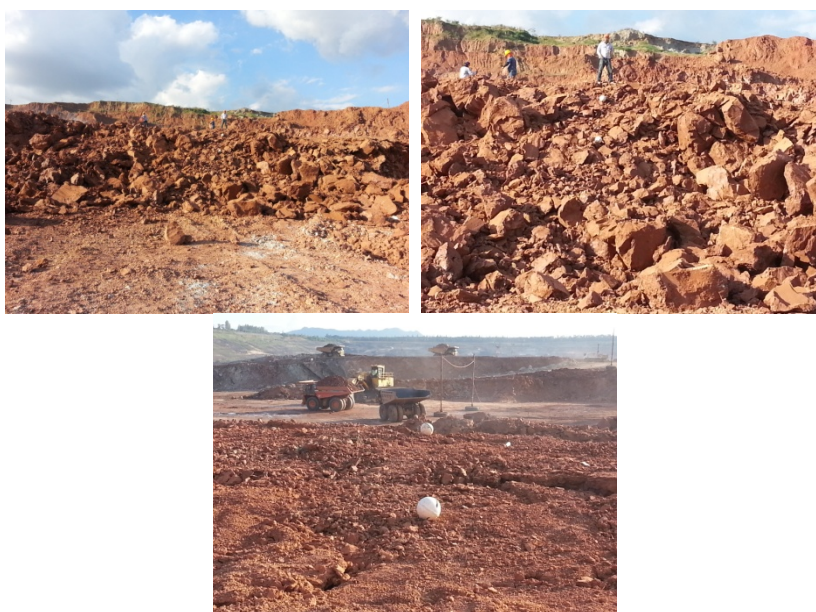
รูปที่ ฉ-8 ผลการระเบิดวันที่ 4 เดือนพฤศจิกายน พ.ศ.2557 ที่ 25 มิลลิวินาที
