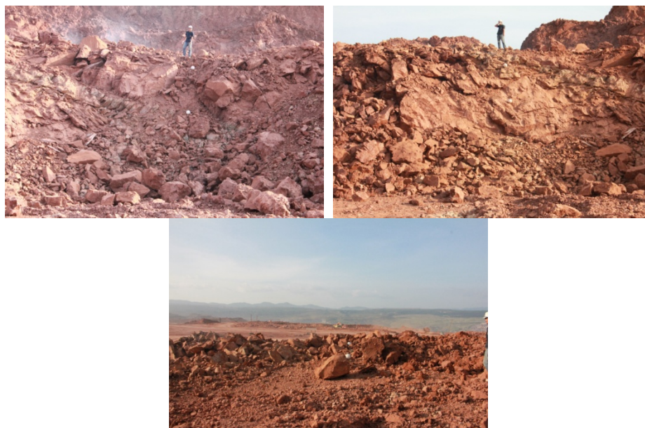
รูปที่ จ-3 ผลการระเบิดวันที่ 3 เดือนธันวาคม พ.ศ.2556 แบบ 1.7 เมตร : 2.3 เมตร
