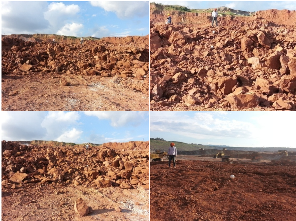
รูปที่ 3.20 ผลการระเบิดโดยใช้หลักการ Wave form interference ถ่วงจังหวะที่ 25 มิลลิวินาที
