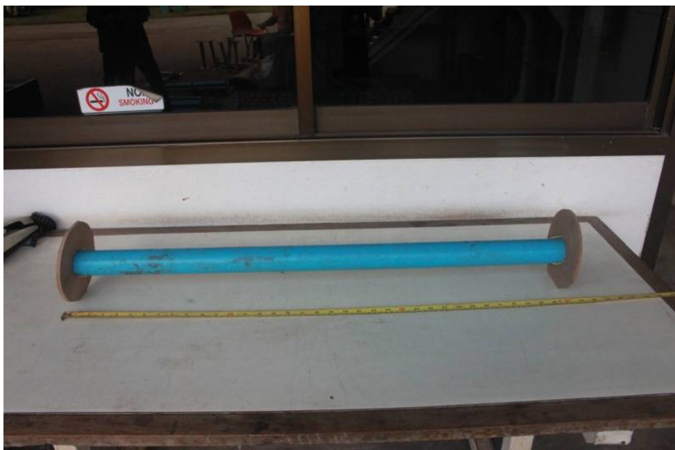
รูปที่ 2.19 ชุดอุปกรณ์สำหรับใช้เป็นช่องว่างในการทำ air-deck ที่ 15 %
