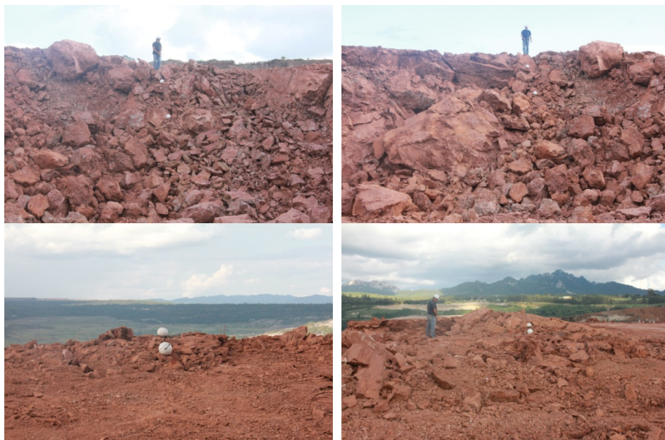
รูปที่ ค-2 ผลการระเบิดวันที่ 18 เดือนพฤศจิกายน พ.ศ.2556 แบบขยายระยะห่างระหว่าง รูเจาะ
