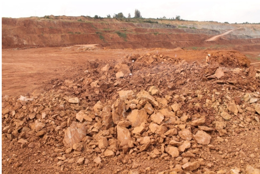
รูปที่ 3.12 การแตกของหินในบริเวณขอบหลุมระเบิดของการระเบิดโดยใช้เทคนิคการแบ่งบรรจุวัตถุระเบิดออกเป็นช่วงกรณีที่ 1 แบบ 1.5 เมตร : 2.5 เมตร
