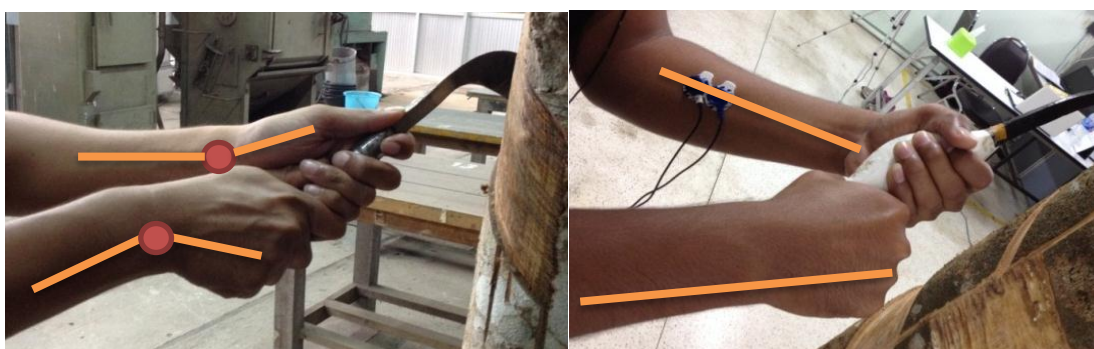
ภาพที่ 4.83 ทำทางการจับกำด้ามมีดกรีดยางแบบดั้งเดิม (ซ้าย) และการจับกำด้ามมีดกรีดยางที่ออกแบบใหม่ (ขวา)
