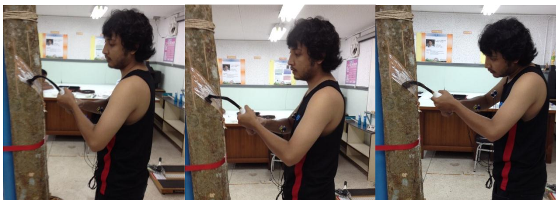
ภาพที่ 4.56 ท่าทางการใช้งานด้ามมีดที่ตรงตามต้นแบบที่ 1 (ซ้าย) แบบที่ 2 (กลาง) และแบบที่ 3 (ขวา)
