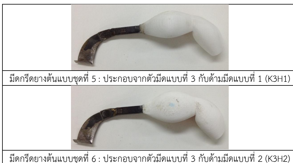
ภาพที่ 4.30 มีดกรีดยางต้นแบบที่มีความแตกต่างกันจำนวน 6 ชุด (ต่อ)
