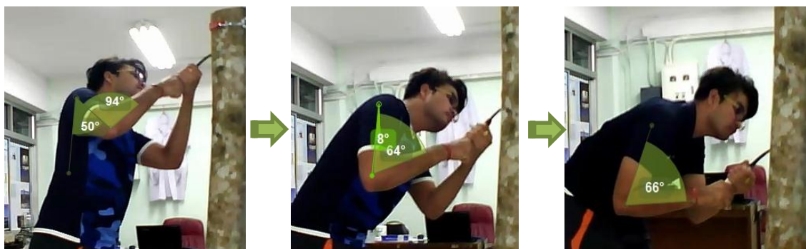
ภาพที่ 4.79 ท่าทางด้านขวาของการทำงานกรีดยางโดยใช้มีดกรีดยางที่ออกแบบใหม่กรีดยางที่มีความสูงระดับสายตา(ซ้าย) ระดับหน้าอก(กลาง) และระดับเอว(ขวา)
