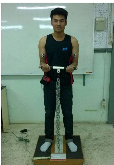
ภาพที่ 3.12 ทำทางการทดสอบค่าการออกแรงสูงสุด(MVC) ของกล้ามเนื้อแขน
