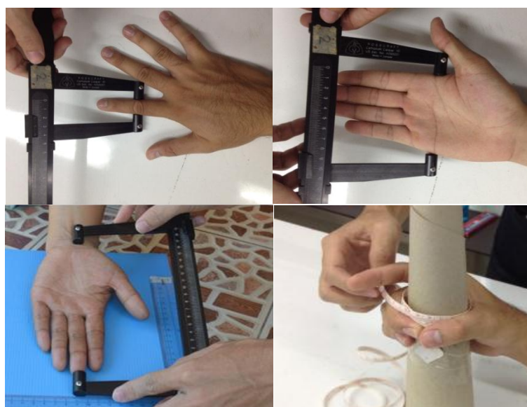
ภาพที่ 4.5 ตัวอย่างการวัดขนาดสัดส่วนร่างกายในส่วนมือของผู้ประกอบอาชีพกรีดยาง
