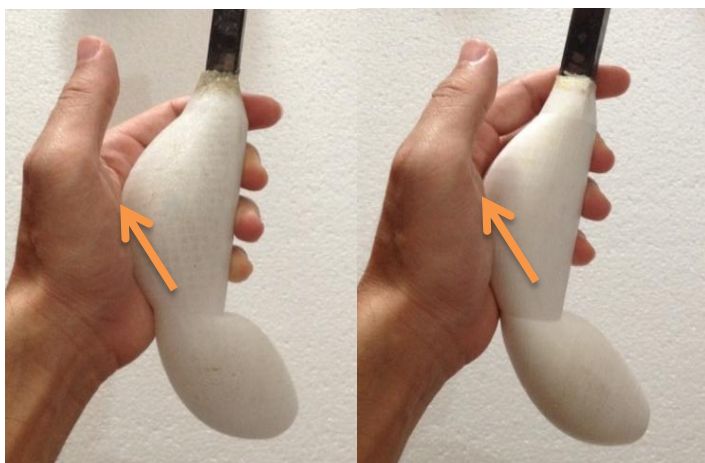
ภาพที่ 4.55 ลักษณะการโอบรับอุ้งฝ่ามือของด้ามมีดที่มีพื้นที่หน้าตัดเป็นวงกลม (ซ้าย) และด้ามมีดที่มีพื้นที่หน้าตัดเป็นวงรี (ขวา)
