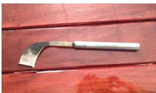
ภาพที่ 3.2 มีดกรีดยางแบบดั้งเดิม(มีดเจ๊ะบง)
