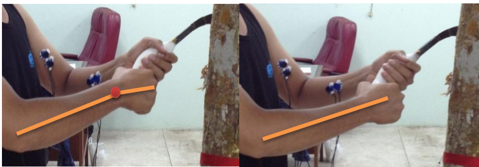
ภาพที่ 4.51 ท่าทางด้านข้างของมือขวาในการจับด้ามมีดกรีดยางต้นแบบที่ 1 (ซ้าย) และท่าทางการจับด้ามมีดกรีดยางต้นแบบที่ 2 (ขวา)
