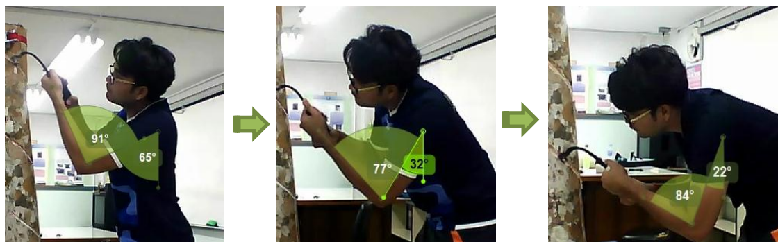
ภาพที่ 4.80 ท่าทางด้านซ้ายของการทำงานกรีดยางโดยใช้มีดกรีดยางที่ออกแบบใหม่กรีดยางที่มีความสูงระดับสายตา(ซ้าย) ระดับหน้าอก(กลาง) และระดับเอว(ขวา)
