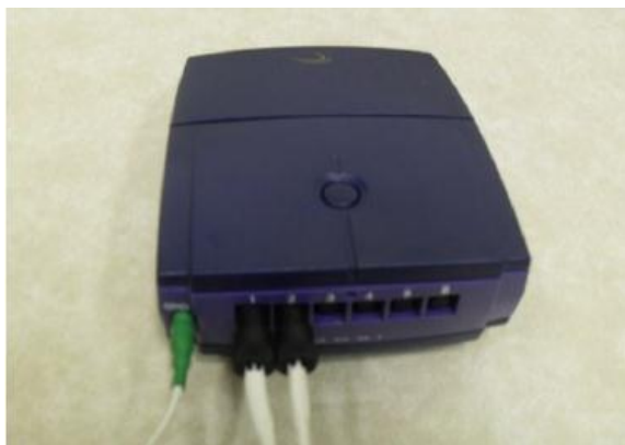
ภาพที่ 2.24 เครื่องขยายสัญญาณไฟฟ้ากล้ามเนื้อ รุ่น Mobi6-6b
