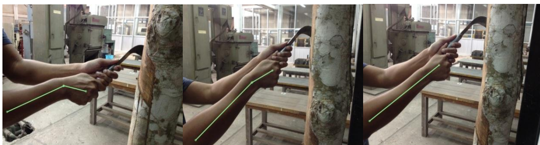
ภาพที่ 4.23 ท่าทางการจับด้ามมีดกรีดยางเบื้องต้น : มีดกรีดยางแบบดั้งเดิม (ซ้าย) มีด Ergo-1 (กลาง) และมีด Anti-CTS (ขวา)
