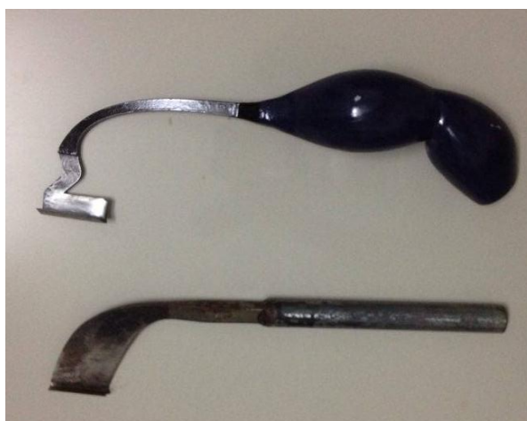
ภาพที่ 4.84 มีดกรีดยางที่ออกแบบใหม่ (บน) และมีดกรีดยางแบบดั้งเดิม (ล่าง)
