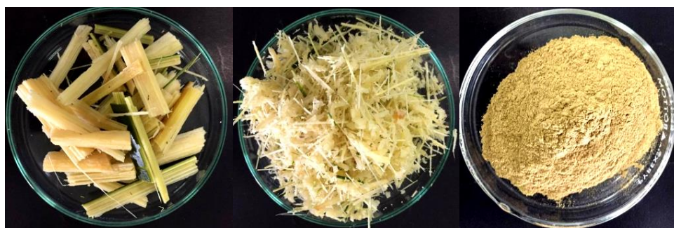
ภาพที่ 3.2 ก้านทางไต้ต้นจากที่ผ่านการตัดให้มีขนาดเล็ก (ก) ก้านทางไต้ต้นจากที่ผ่านการบดหยาบ (ข) และก้านทางไต้ต้นจากที่ผ่านการบดละเอียด (ค)
