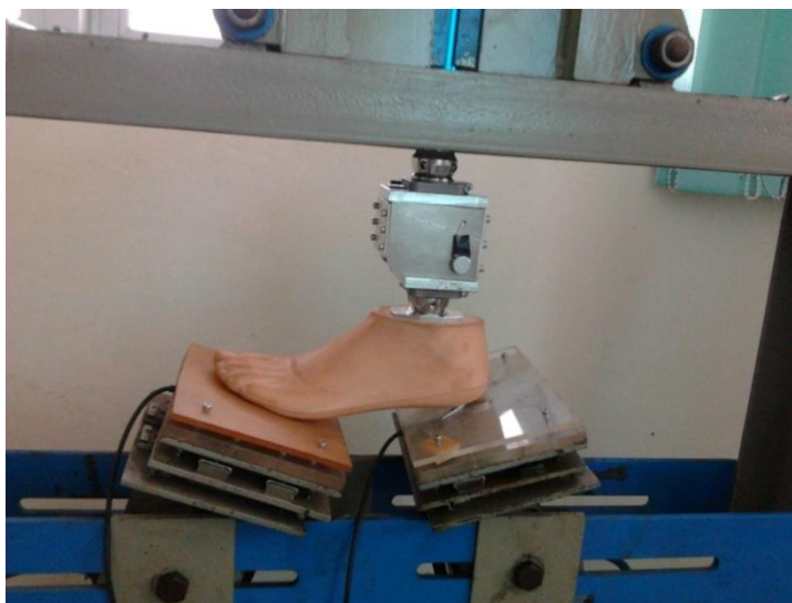
รูปที่ 4-7 การติดตั้งเท้าเทียมบนเครื่องทดสอบเท้าเทียม
