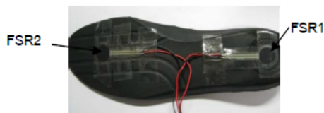
รูปที่ 3 เซนเซอร์วัดแรงกดใต้แผ่นรองฝ่าเท้า
