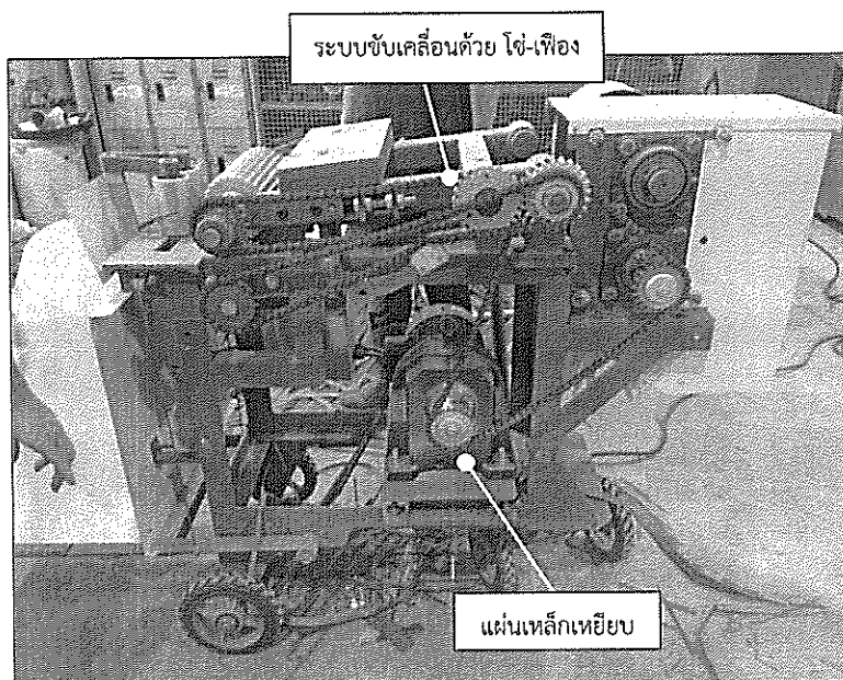
รูปที่ 3 เครื่องแยกใบปาล์มออกจากทางปาล์มน้ำมัน
