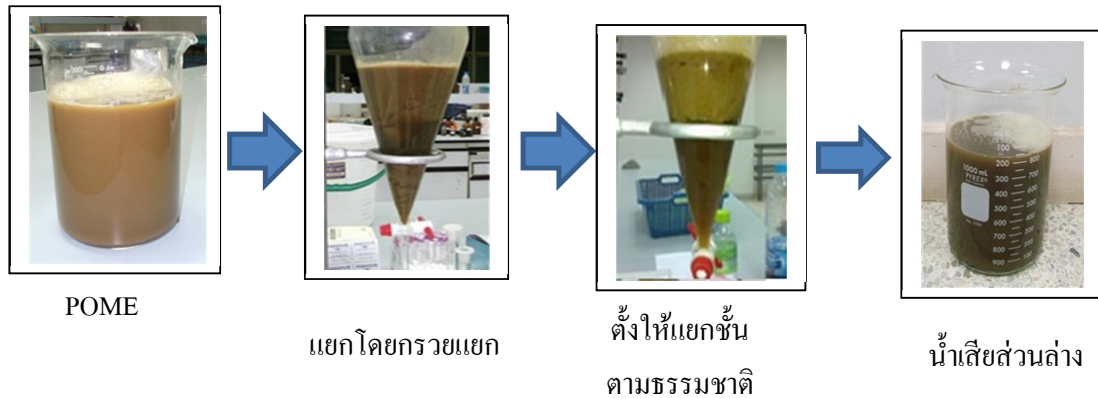
ภาพประกอบที่ 3-7 แสดงการแยกชั้นไขมันในขั้นตอนการเตรียมน้ำเสียตั้งต้น
