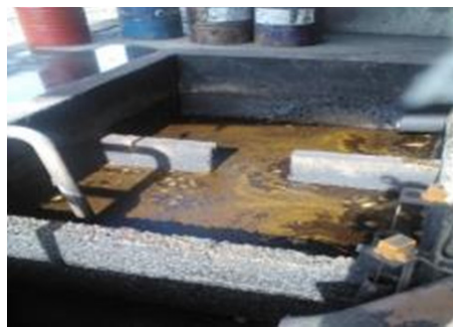
ภาพประกอบที่ 2-8 น้ำเสียจากเครื่องเหวี่ยงแยก ที่มา: บริษัทพิทักษ์ปาล์มออยล์ จำกัด
