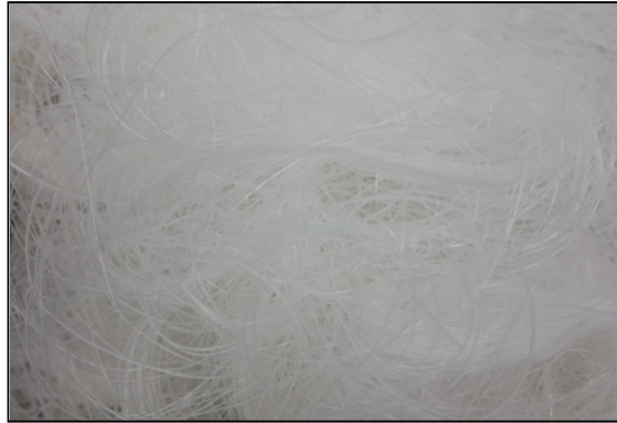
ภาพประกอบที่ 3-3 Polypropylene (PP) ชนิด fiber
