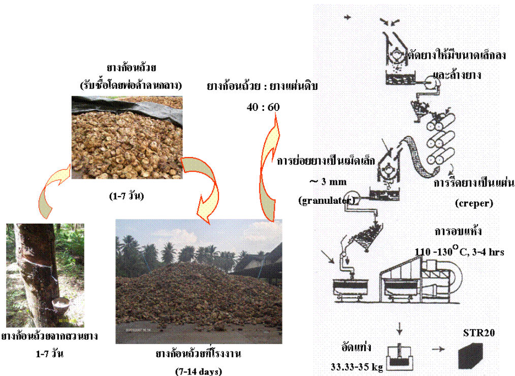
รูปที่ 2-2 กระบวนการผลิตยางแถ้ง STR 20
