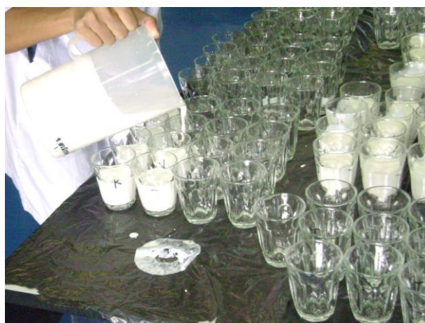
รูปที่ 2-3 การเทน้ำยางประมาณ 60 mL ลงในแก้วที่เตรียมไว้
