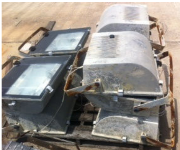
รูปที่ 3.28 โคมไฟเสาส่งไฟฟ้าแรงสูง (High mast) ขนาด 1,000 วัตต์ ที่ถอดออกมา
