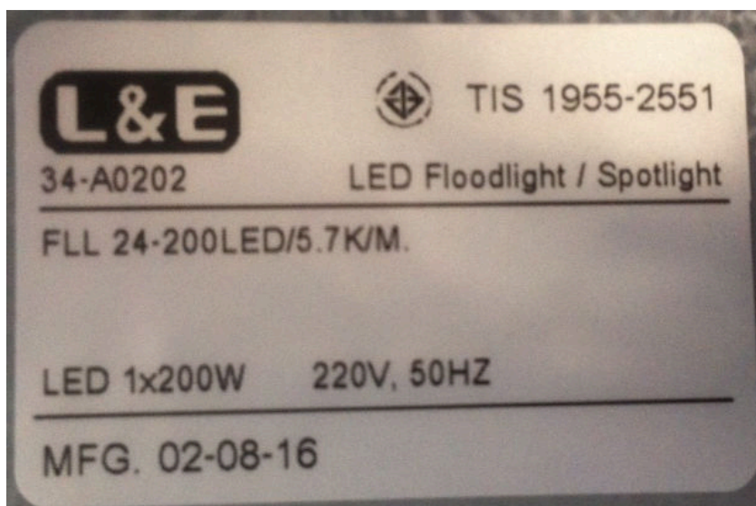
รูปที่ 3.18 Name plate โคมไฟส่องสนาม LED (Flood light) ขนาด 200 วัตต์
