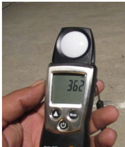
รูปที่ 3.34 การวัดค่าแสงสว่างโคมไฟเสาสูงไฟฟ้าแรงสูง LED
