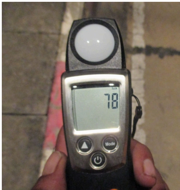
รูปที่ 3.13 การวัดค่าแสงสว่างโคมไฟถนน LED (Street light) ขนาด 122 วัตต์
