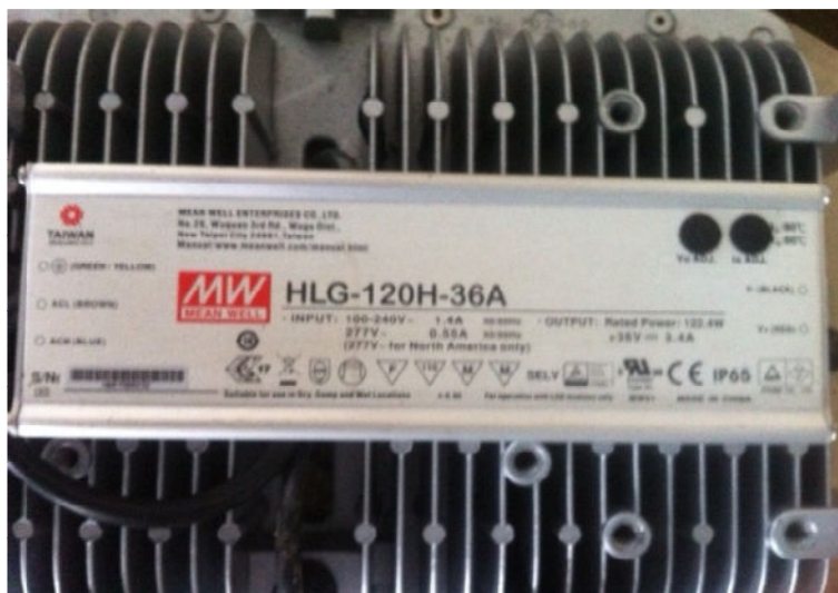
รูปที่ 3.9 ไดรเวอร์โคมไฟถนน LED (Street light) ขนาด 122 วัตต์
