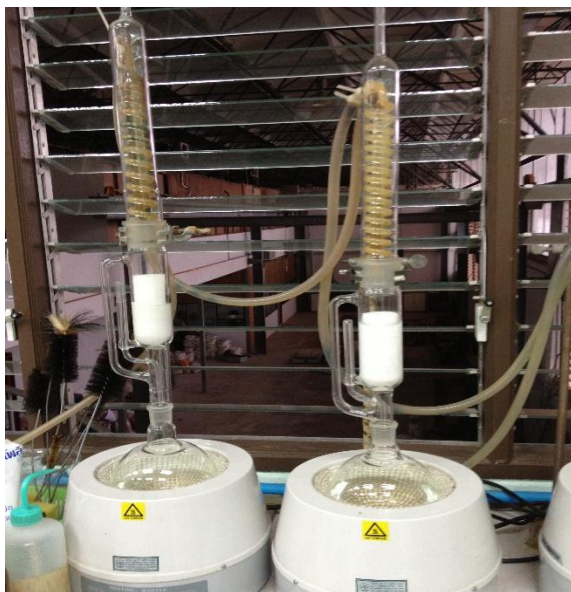
รูปที่ 3-14 การทำความสะอาดเรซินด้วยวิธีการ soxhlet extraction
