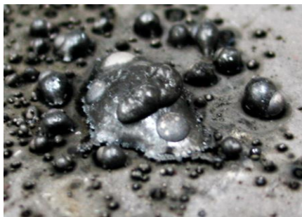
รูปที่ 41 ลักษณะทางกายภาพชิ้นงานของสารผลิตภัณฑ์ที่สังเคราะห์ด้วยปฏิกิริยา SHS จากระบบสารตั้งต้น WO_3+Si+Al
