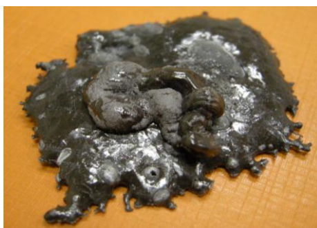
รูปที่ 44 ลักษณะทางกายภาพชิ้นงานของสารผลิตภัณฑ์ที่สังเคราะห์ด้วยปฏิกิริยา SHS จากระบบสารตั้งต้น \text{WO}_3 + \text{B}_2\text{O}_3 + \text{Al}
