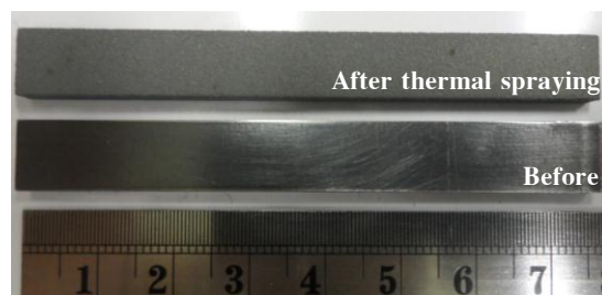
รูปที่ 122 ลักษณะของสารประกอบเชิงโลหะ W_2B ที่ถูกเคลือบลงบนวัสดุฐาน หลังจากผ่านกระบวนการพ่นเคลือบด้วยเปลวความร้อน
