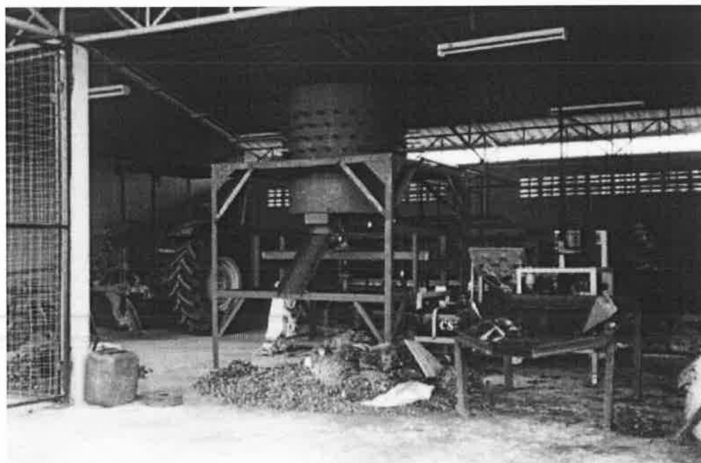
รูปที่ 2.9 เครื่องแยกผลปาล์มออกจากทะลายปาล์มน้ำมัน ขณะใช้งาน ที่มา: จำลอง ปราบแก้ว และคณะ (2545)
