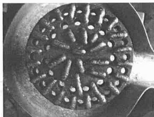
(3) หน้าจันที่เจาะเป็นรูขนาดเส้นผ่านศูนย์กลาง 1.2 เซนติเมตร ทั่วทั้งหน้าจัน และมีรอยเชื่อมขนาด 0.8x3.5 เซนติเมตร จำนวน 32 รอย ด้านบนหน้าจัน
