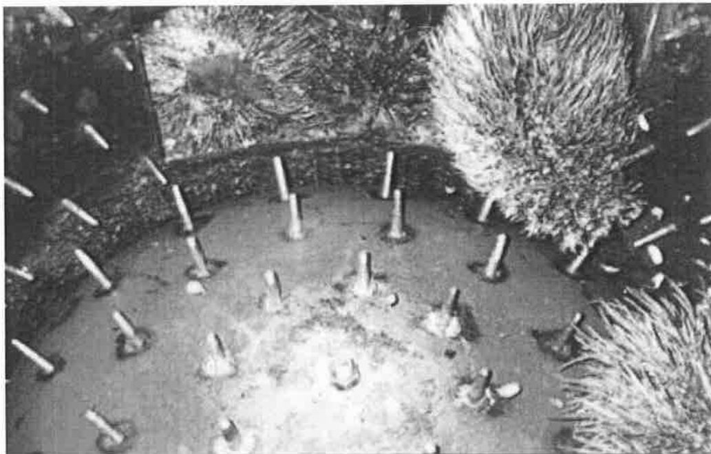
รูปที่ 2.10 ทะลายที่เหลือแต่ซี่งขณะกำลังถูกเหวี่ยงออกทางประตูทางออกซังปาล์ม ที่มา: จำลอง ปราบแก้ว และคณะ (2545)
