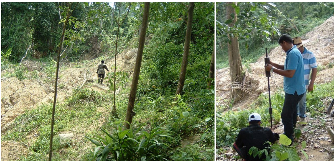
(ก) ทดสอบกำลังรับน้ำหนักของดินด้วยวิธีเจาะหยั่งแบบเบ้า Kunzelstab Penetration Test ทางด้านขวาของรอยพิบัติบริเวณตำแหน่ง T
