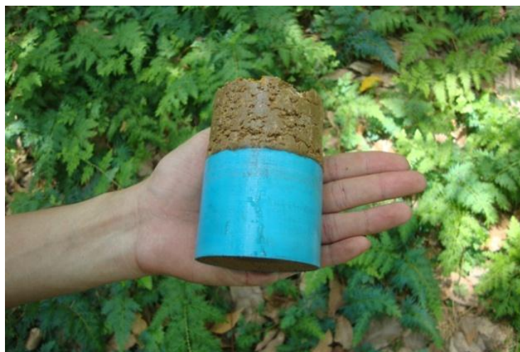
(ข) ตัวอย่างดินแบบไม่ถูกรบกวน (Undisturbed Sample) เมื่อดันออกจากกระบอกเหล็กแล้ว รูปที่ 3.4 การเก็บตัวอย่างดินแบบคงสภาพ (Undisturbed Sample)
