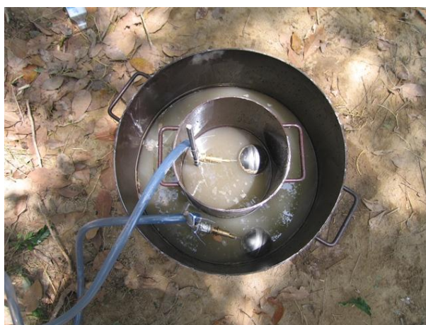
(ข) ชุดควบคุมการไหลของน้ำเข้าสู่โลหะทรงกระบอก รูปที่ 3.7 การทดสอบความชื้นน้ำด้วยวิธี Double Ring Test
