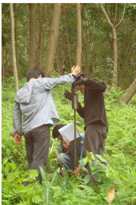
รูปที่ 3.6 การทดสอบวิธีหยั่งเบา Kunzelstab Penetration Test
