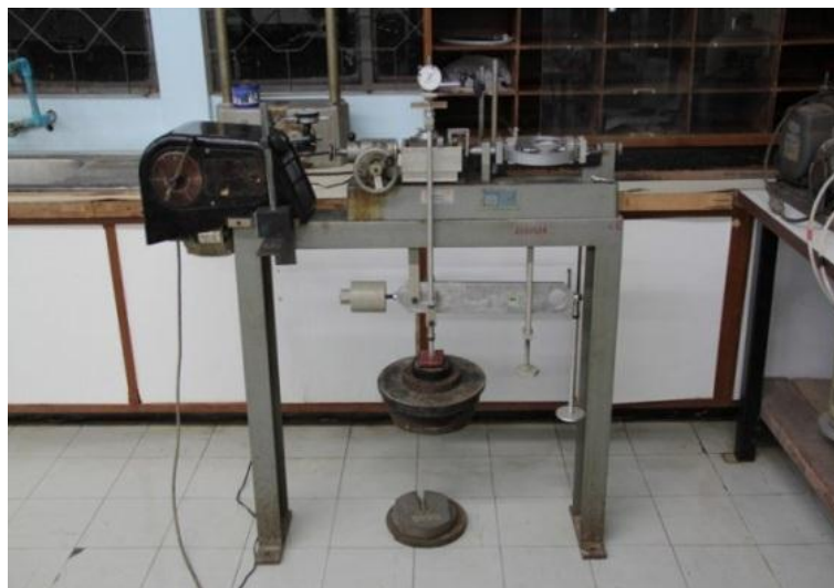
(ข) ขณะทดสอบเฉือนตัวอย่างดิน
