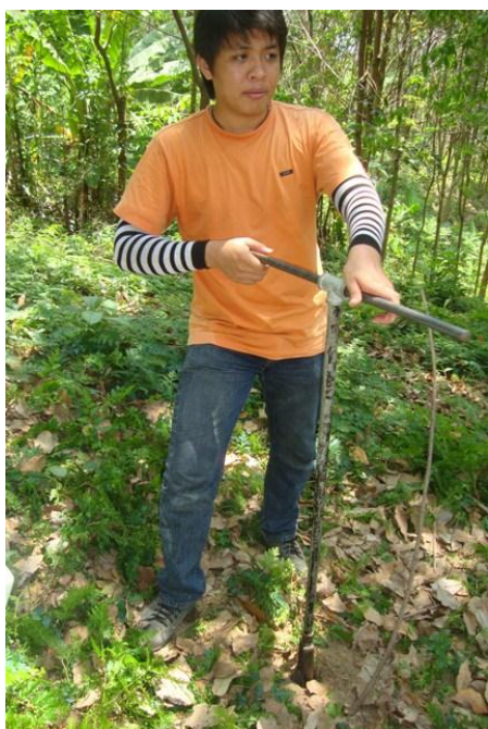
(ก) การเก็บตัวอย่างดินโดยใช้สว่านมือ (Hand Auger)
