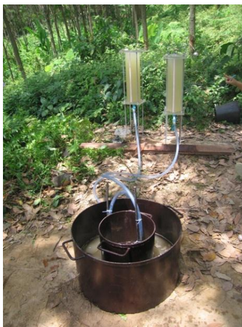
(ก) การวัดค่าความชื้นน้ำของดิน โดยใช้ Double Ring Test
