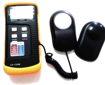
รูปที่ 11 เครื่อง Digital Light Meter Model LX-1330B ใช้สำหรับวัดความเข้มแสง
