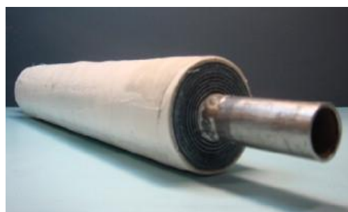
รูปที่ 1-5 ลักษณะเมมเบรนแบบท่อม้วน ที่มา: Sairam et al. (2010)
