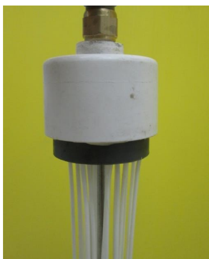
รูปที่ 2-6 ลักษณะชุดเมมเบรนแบบใหม่ที่ยังไม่ผ่านการกรอง
