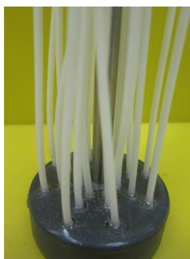
รูปที่ 2-6 ลักษณะชุดเมมเบรนแบบใหม่ที่ยังไม่ผ่านการกรอง
