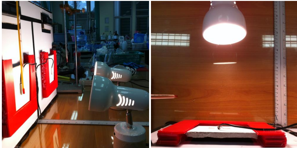
รูปที่ 4.32 ลักษณะการให้ความร้อนและวัดความร้อนบนแผ่นปูนซีเมนต์ทำด้วยตัวอย่าง
