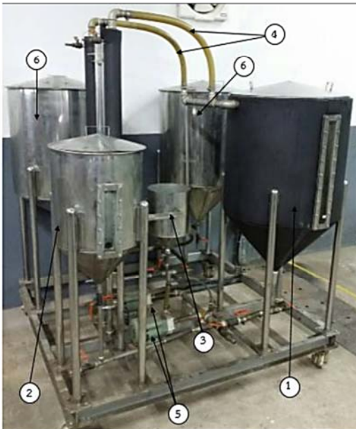
รูปที่ 1 เครื่องผลิตเอทิลเอสเตอร์จากน้ำมันปาล์มดิบชนิดกรดไขมันอิสระสูงด้วยท่อผสม แบบสติกหมุนวนขนาด 100 ลิตร (1: ถังน้ำมันปาล์มดิบ ขนาด 180 ลิตร, 2: ถังเอทานอล ขนาด 70 ลิตร, 3: ถังกรดซัลฟิวริก ขนาด 20 ลิตร, 4: ท่อผสมแบบสติกจำนวน 2 ชุดท่อ, 5: บีมสารเคมีแบบหมุนวน และ 6: ถังเก็บไอโอดีเซล)
