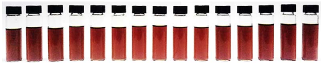
รูปที่ 3 แสดงตัวอย่างลักษณะน้ำมันที่ได้จากเงื่อนไขการทดลอง 1-6 และเงื่อนไขการทดลองที่ 10 ที่ไม่มีการแยกชั้นของกลีเซอรอลและเอซิลเอสเทอร์เหมือนกันทั้งหมด
