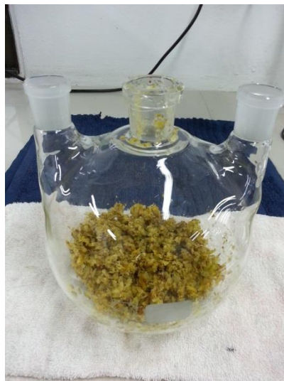
รูปที่ 4 แสดงเปลือกสับประรดผสมน้ำสะอาดในโถแก้ว 3 คอ ขนาด 2 ลิตร ก่อนการปรับสภาพโดยให้ความร้อนด้วยคลื่นไมโครเวฟ
