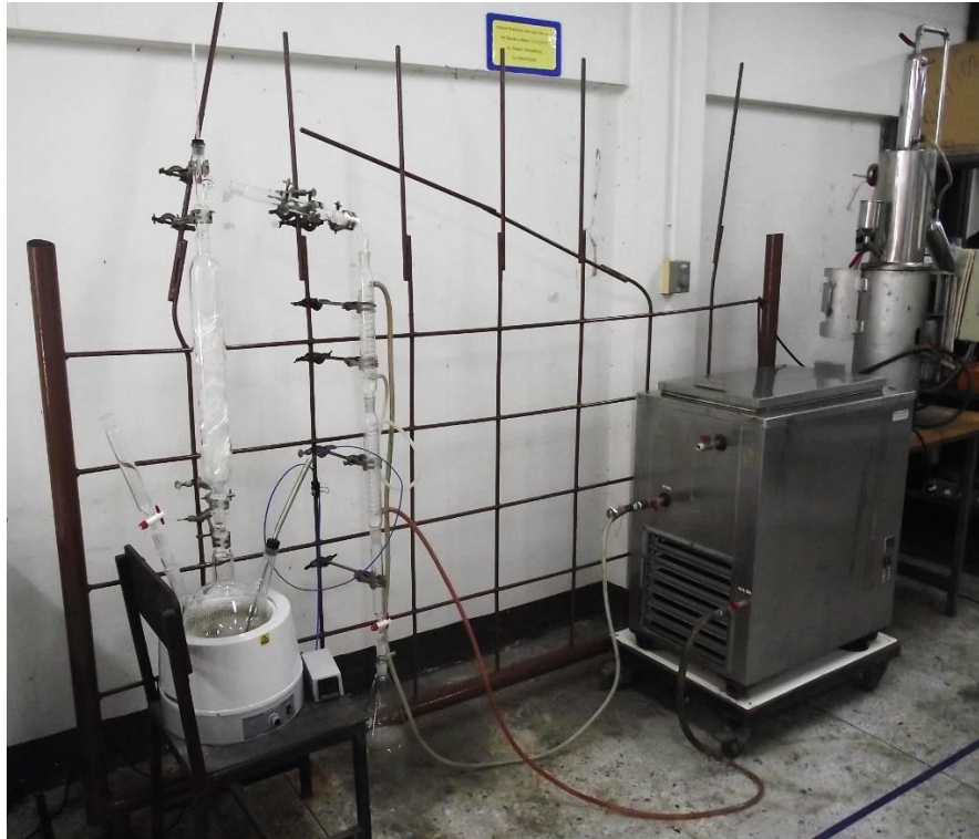
รูปที่ 60 แสดงชุดเครื่องมือสำหรับกลั่นเพิ่มความบริสุทธิ์เอทานอล สร้างขึ้นด้วยงบประมาณจากงานวิจัยก่อนหน้านี้ (โครงการ “การผลิตเอทานอลจากเมล็ดขนุน” ทุนงบประมาณแผ่นดินปี 2553-2554) [13]
