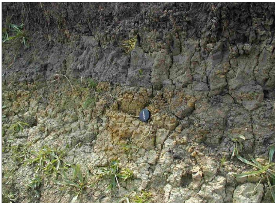
รูปที่ 2.8 รอยแตกบริเวณผิวของริมตลิ่ง (Wynn, 2004)
