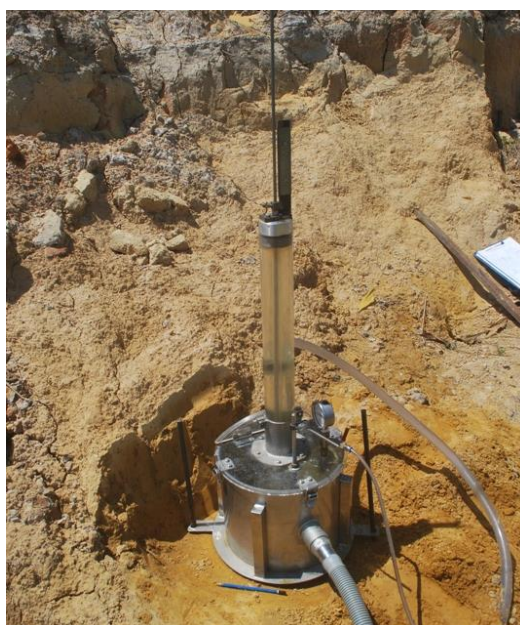
รูปที่ ข2 การติดตั้งเครื่องการทดสอบการกัดเซาะตลิ่งในสนาม (Submerged jet device)
