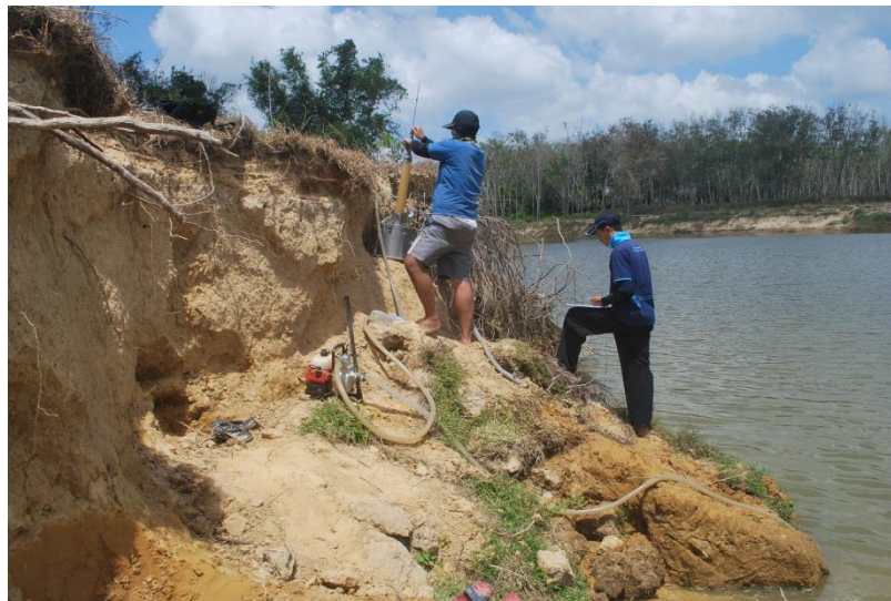
รูปที่ 3.6 การทดสอบ Submerged jet test บริเวณตลิ่งคลองอุตะเภามืองช้าง
