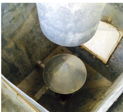
รูปที่ 3.14 อุปกรณ์ปล่อยฟองอากาศในถังล่อย
