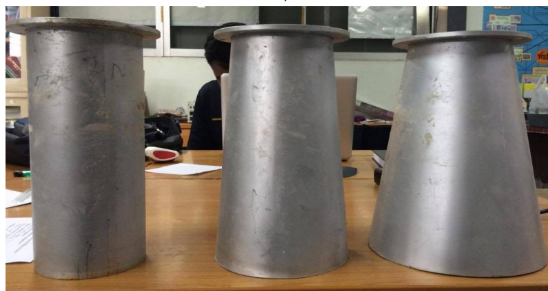
รูปที่ 3.10 ดาวคัมเมอร์ a) ขนาดความสูง 25 เซนติเมตร ที่ได้ออกแบบไว้ b) ที่ได้ออกแบบไว้ทั้ง 3 ขนาด c) ที่ได้จัดทำขึ้นทั้ง 3 ขนาด
