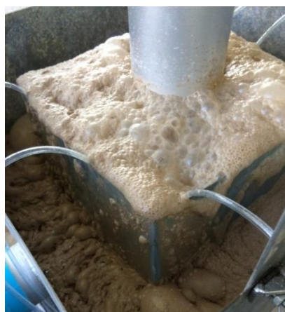
รูปที่ 3.17 การลอยแร่ที่ได้ติดตั้งวัสดุปล่อยฟองอากาศเพิ่ม
