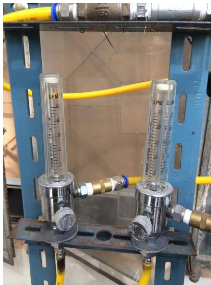
รูปที่ 3.12 เครื่องวัดอัตราการไหลของอากาศ
