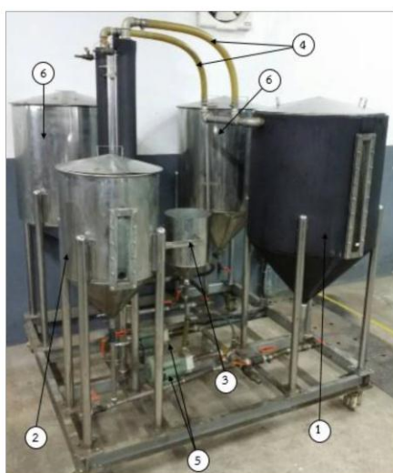
รูปที่ 1 เครื่องผลิตเอทิลเอสเทอร์จากน้ำมันปาล์มดิบชนิดกรดไขมันอิสระสูงด้วยท่อผสมแบบสติดหมุนวนขนาด 100 ลิตร (1: ถังน้ำมันปาล์มดิบ ขนาด 180 ลิตร, 2: ถังเอทานอล ขนาด 70 ลิตร, 3: ถังกรดซัลฟิวริก ขนาด 20 ลิตร, 4: ท่อผสมแบบสติดจำนวน 2 ชุดต่อ, 5: ปั๊มสารเคมีแบบหมุนวน และ 6: ถังเก็บใบโอดีเซล)
