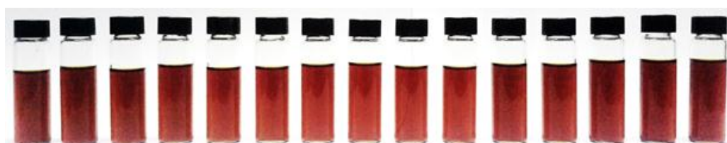
รูปที่ 4.12 แสดงตัวอย่างลักษณะน้ำมันที่ได้จากเงื่อนไขการทดลอง 1-6 และเงื่อนไขการทดลองที่ 10 ที่ไม่มีการแยกชั้นของกลีเซอรอลและเอทิลเอสเทอร์เหมือนกันทั้งหมด
