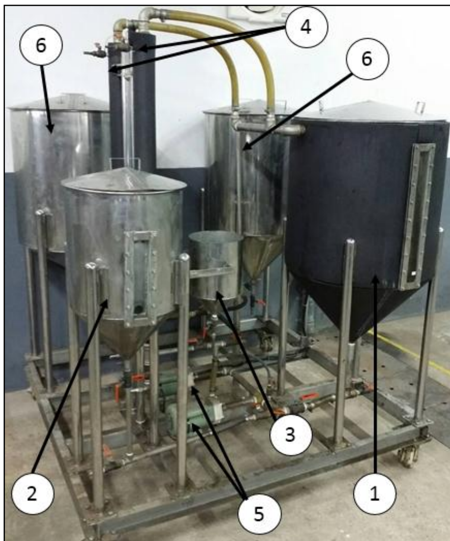
รูปที่ 3.4 ชุดปฏิกรณ์ท่อผสมสติดแบบหมุนวนในการทดลองการลดกรดไขมันอิสระในน้ำมันปาล์มดิบ ที่รวบรวมชนิดกรดไขมันอิสระสูง
