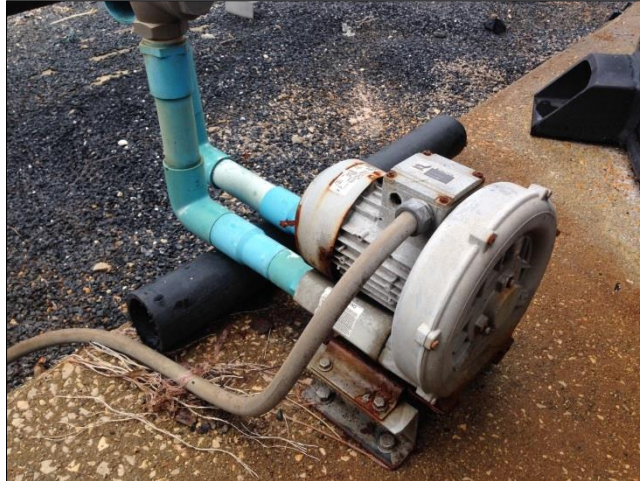
ภาพที่ 29 เครื่องอัดอากาศให้แก่กองปุ๋ยหมัก
