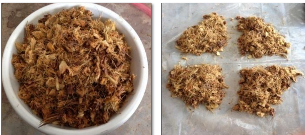
ภาพที่ 14 การเตรียมตัวอย่างทะลายเปล่าปาล์มน้ำมันที่ไม่ผ่านการหีบ
