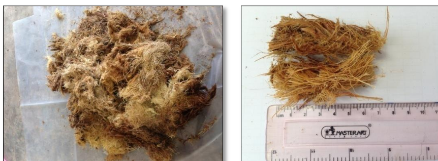
ภาพที่ 12 ทะลายเปลือกปาล์มน้ำมันที่ผ่านการหีบ
