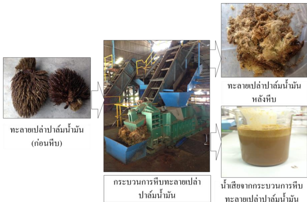
ภาพที่ 8 กระบวนการหีบทะเลลายเปล่าปาล์มน้ำมัน
