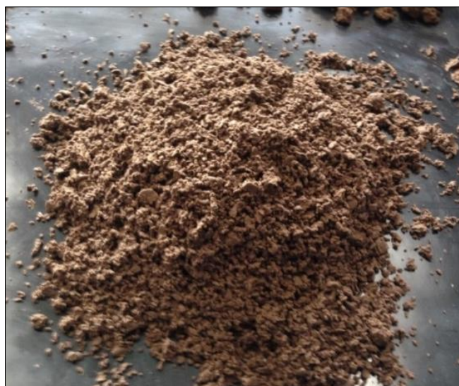
ภาพที่ 20 กากตะกอนดีแคนเตอร์ หลังร่อนผ่านตะแกรงขนาด 0.5 มิลลิเมตร
