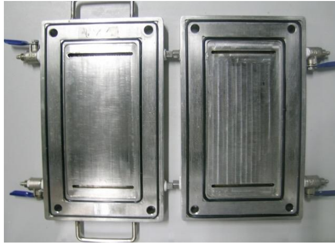
Figure 2.4. FO membrane module
