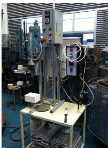
รูปที่ 3.4 เครื่องเตรียมน้ำโลหะแบบกึ่งของแข็งด้วยการปล่อยฟองแก๊ส, GISS
