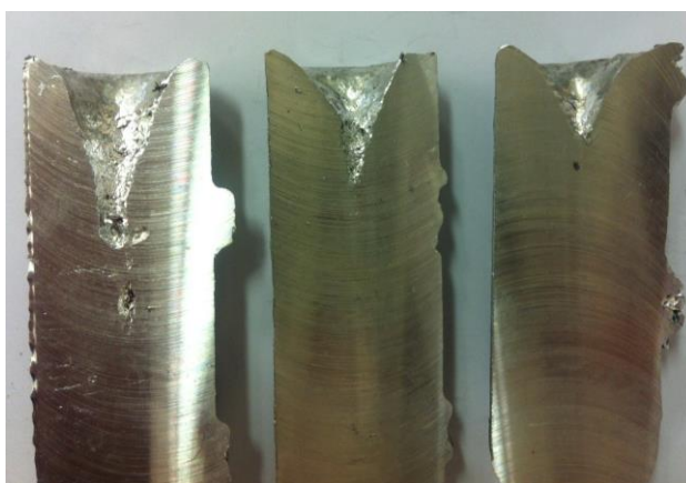
รูปที่ 4.31 ลักษณะการหลุดตัวของชิ้นงานที่ SSM5, SSM10 และ SSM15 วินาที
