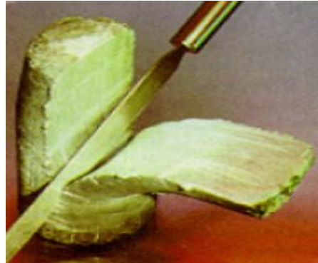
รูปที่ 2.3 แสดงสมบัติการไหลคล้ายไอศกรีมของโลหะกิ่งของแข็ง [1] [5]
