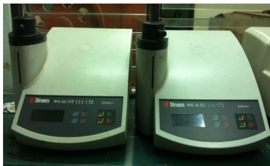
รูปที่ 3.12 เครื่อง mounting ชิ้นงาน รุ่น Struers A/S DK 2750 Ballerup
