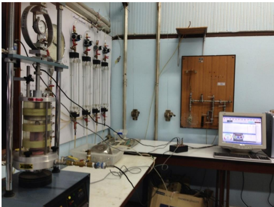
รูปที่ 3.6 เครื่องมือการทดสอบแรงอัดสามแกนอุปกรณ์บันทึกผลและอุปกรณ์วัดค่าต่างๆ
