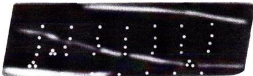
รูปที่ 2.5 ภาพ Radiograph แสดงแถบเฉือนที่เกิดขึ้นในดินทรายละเอียดแน่น จุดสีขาวแสดงตำแหน่งตะกั่วที่ใช้ในการตามการเคลื่อนที่ภายใน ส่วนเส้นสีขาวแสดงแถบเฉือน [9]
