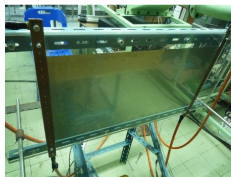
รูปที่ 3.6 แสดงรายละเอียดของผนังที่เจ็ทพุ่งชนบนพื้นผิว
