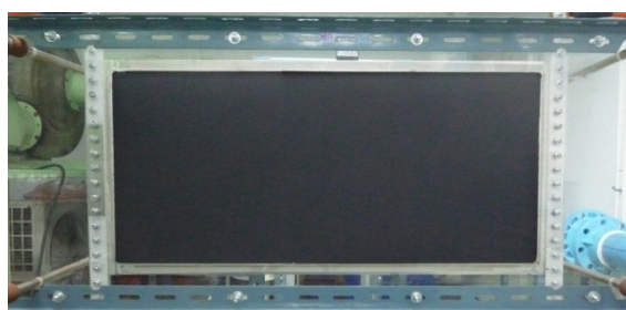
รูปที่ 3.6 แสดงรายละเอียดของผนังที่เจ็ทพุ่งชนบนพื้นผิว
