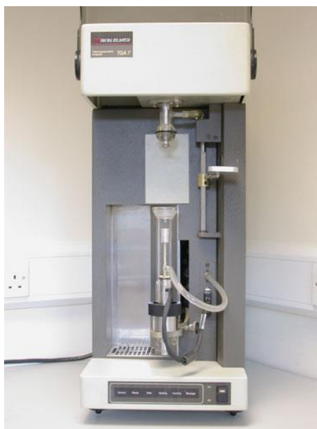
ภาพที่ 3.16 เครื่องวิเคราะห์การเปลี่ยนแปลงน้ำหนักของสารโดยอาศัยสมบัติทางความร้อน ที่มา : ศูนย์เครื่องมือวิทยาศาสตร์ มหาวิทยาลัยสงขลานครินทร์ [61]
