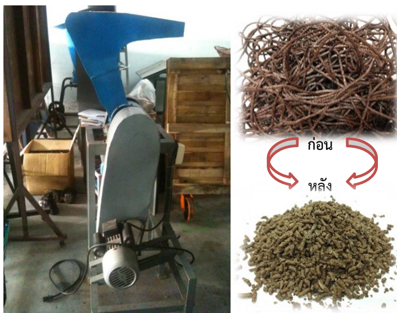
ภาพที่ 3.8 เครื่องย่อยพลาสติกและวัสดุดิบสำหรับป้อนเข้า
