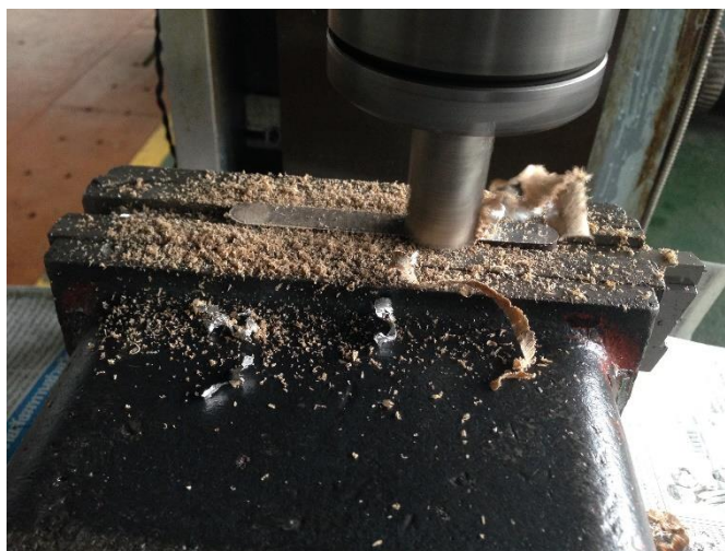
ภาพที่ 3.33 เตรียมชิ้นงานทดสอบด้วยเครื่องกัดแนวตั้ง
