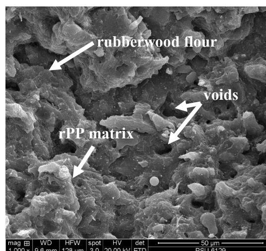
ภาพที่ 4.2 โครงสร้างสัณฐานวิทยาของวัสดุผสมพอลิโพรพิลีนและผงไม้ยางพารา ที่ผสมและขึ้นรูปด้วยกระบวนการอัดรีดแบบเกลียวคู่
