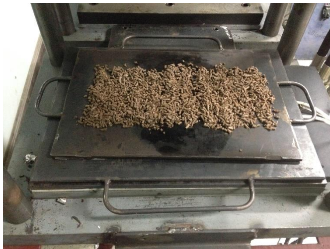
ภาพที่ 3.31 ขั้นตอนการใส่เม็ดวัสดุผสมลงแม่พิมพ์อัดร้อน
