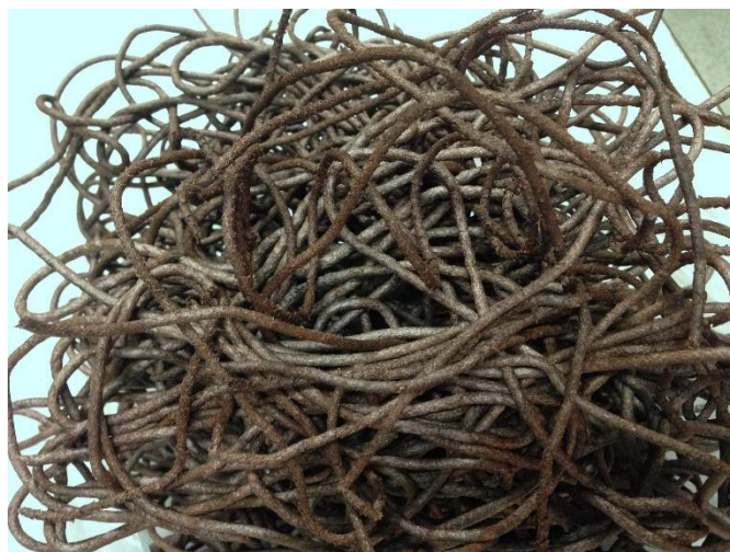
ภาพที่ 3.29 เส้นวัสดุผสมที่ผ่านกระบวนการอัดรีด
