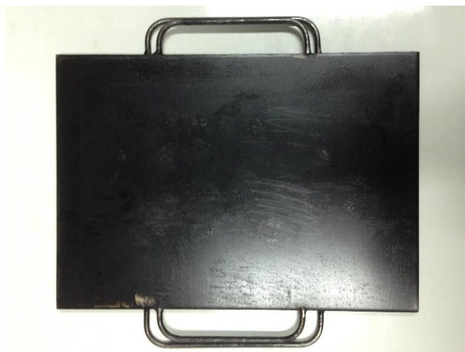
ภาพที่ 3.11 แม่พิมพ์แผ่นบนและแม่พิมพ์แผ่นล่าง
