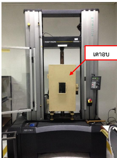
ภาพที่ 3.14 เตาอบสำหรับเครื่องทดสอบวัสดุ
