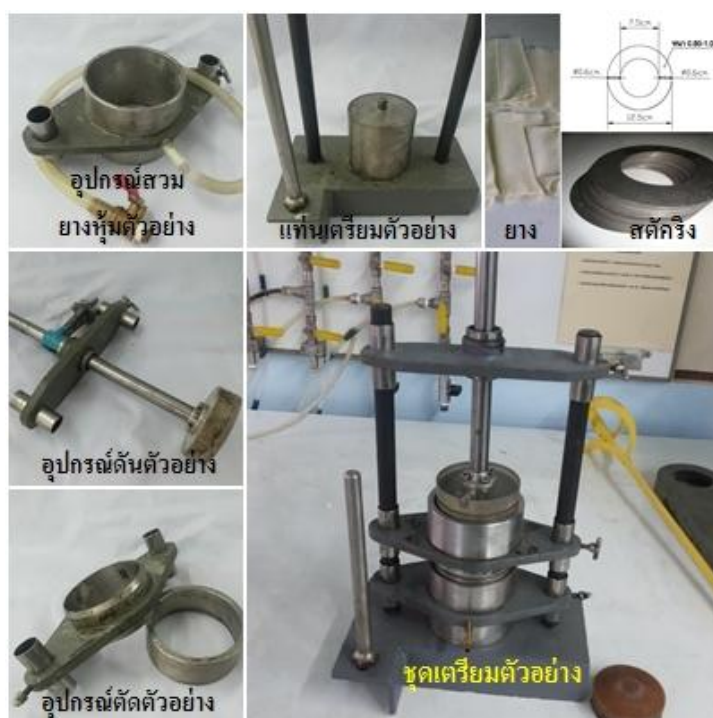
รูปที่ 3.2 ชุดอุปกรณ์การเตรียมตัวอย่างสำหรับการทดสอบการเหือนแบบตรงอย่างง่าย
