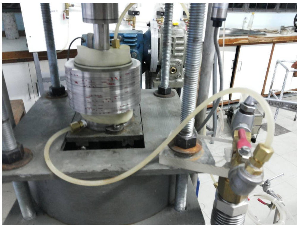
รูปที่ 3.18 ขั้นตอนการทำให้ตัวอย่างดินอิ่มตัวด้วยน้ำ (Saturation)
