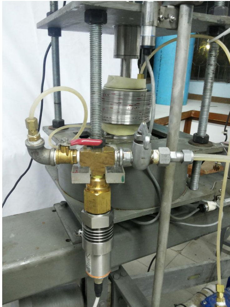
รูปที่ 4.6 การทดสอบกำลังรับแรงเฉือนของเมนเบรนและสแตคริง
