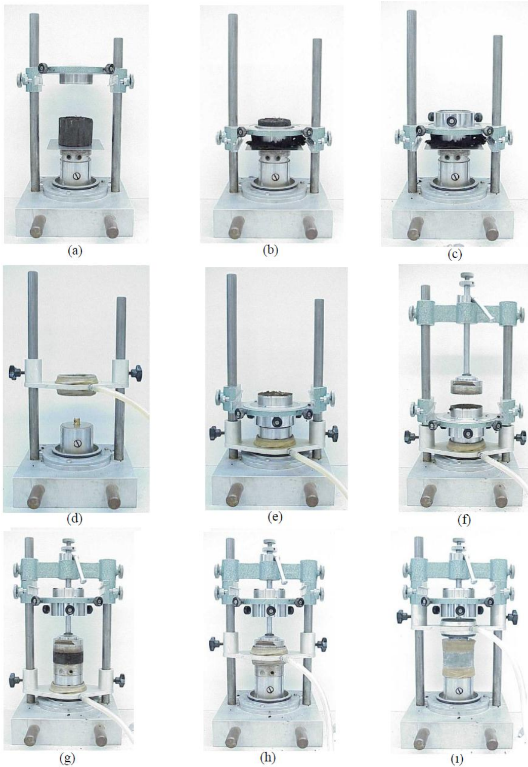
รูปที่ 2.21 แสดงขั้นตอนการเตรียมตัวอย่างสำหรับเครื่องทดสอบของบริษัท GEONOR สำหรับการ ใช้ยางเสริมลวด (Reinforced Membrane) ในการควบคุมปริมาตรคงที่ (Bjerrum and Landva 1966)
