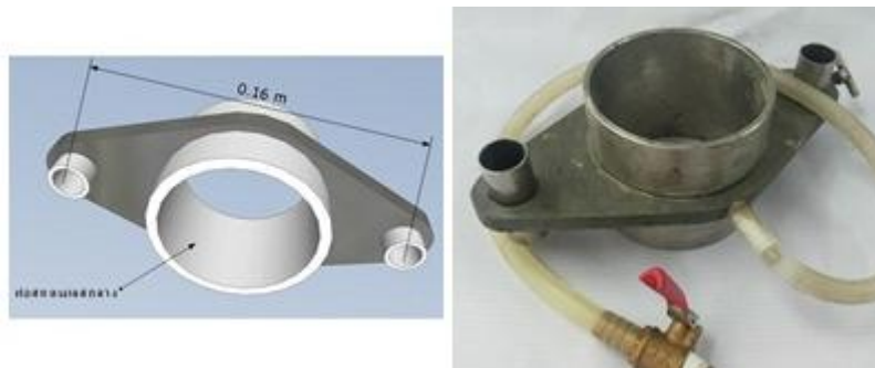
ดั่งภาพที่ 1.5 แสดงอุปกรณ์สวมยางหุ้มตัวอย่างดิน
