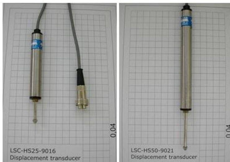
ภาพที่ 1.11 แสดงรายละเอียดคุณสมบัติของ LVDT
