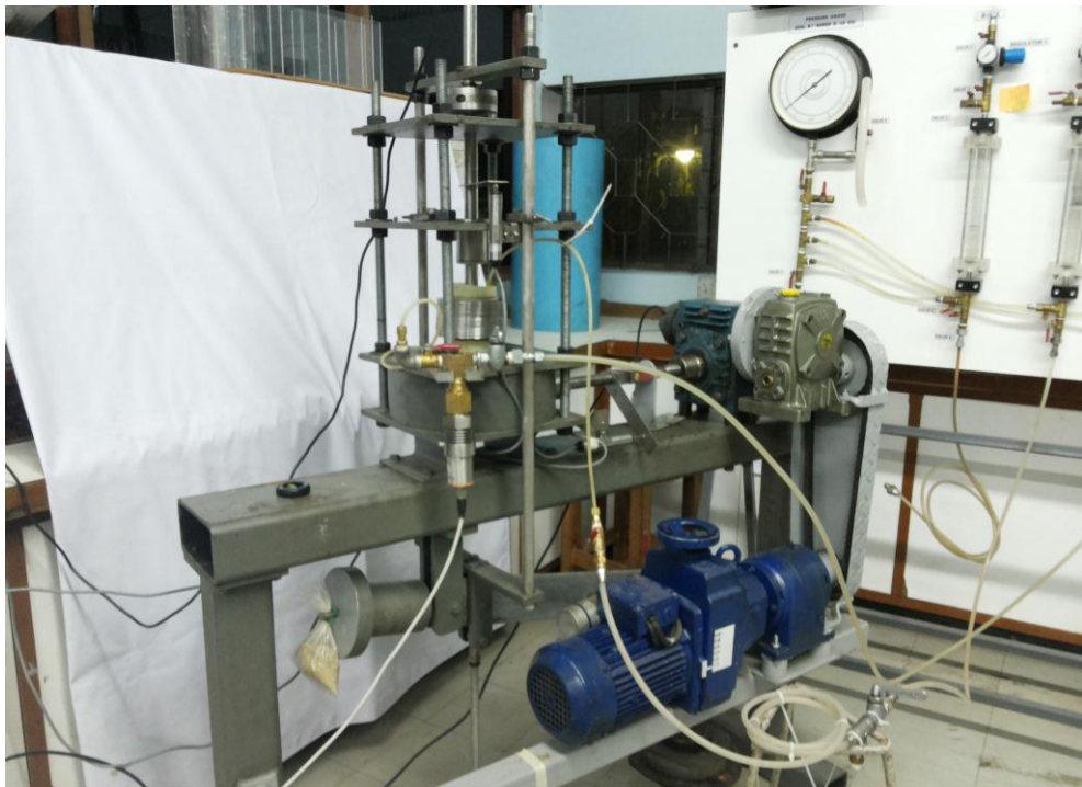
รูปที่ 4.3 แสดงการติดตั้งระบบสำหรับทดสอบการไหลแบบตรงอย่างง่าย
