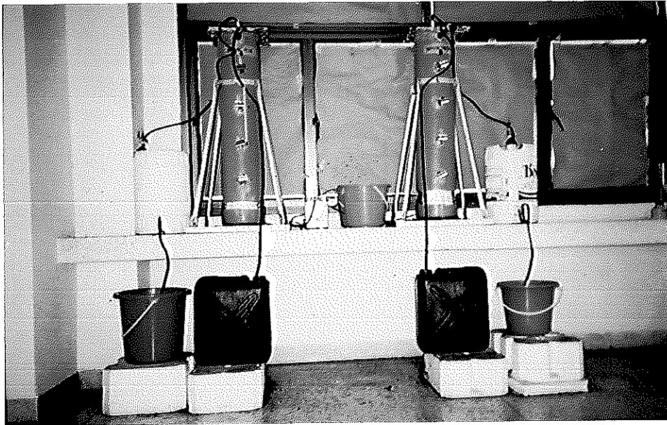
ภาพประกอบ 7 ลักษณะของชุดประกอบของระบบบำบัดน้ำเสียจำลองถึงกรองไร้อากาศ และถังหมักไร้อากาศ ที่ใช้ในห้องปฏิบัติการ
