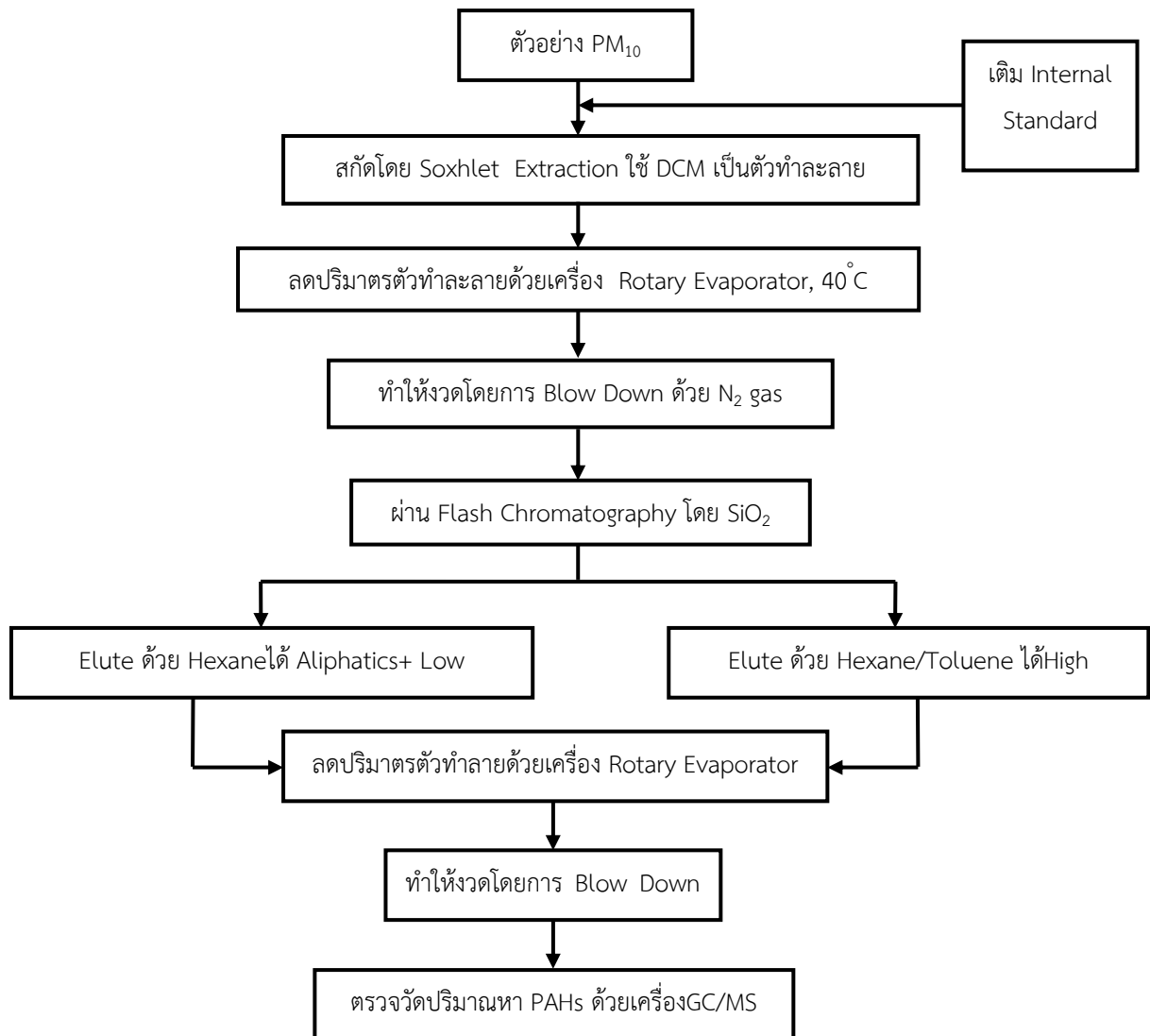
รูปที่ 2-6 แผนผังสรุปขั้นตอนการสกัดและวิเคราะห์ตัวอย่างฝุ่นละออง
