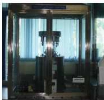
ภาพที่ จ 23. Turbine oil oxidation stability tester (TOST)
