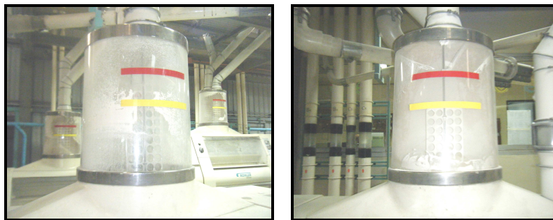
ภาพที่ ค 12. การติดแถบสีเพื่อควบคุมปริมาณวัสดุดิบในหลอดแก้วของเครื่องโม่ข้าวสาลี
