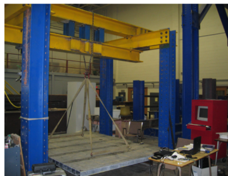
รูปที่ 1 ขั้นตอนการติดตั้งเครื่องมือการทดสอบแผ่นพื้นสะพาน ProDeck 4 (Aluri , 2006) [4]
