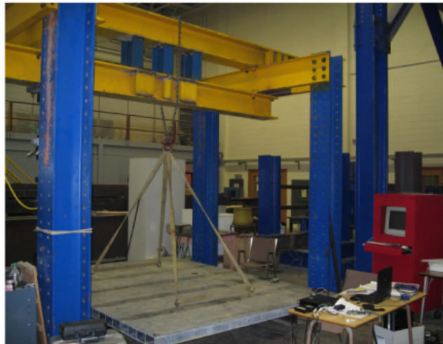
รูปที่ 4.4 ขั้นตอนการติดตั้งเครื่องมือการทดสอบแผ่นพื้นสะพาน Prodeck 4 (Aluri, 2006)
