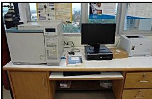
ภาพประกอบที่ 3-2 เครื่องแก๊สโครมาโตกราฟี (Gas chromatography, GC) รุ่นHP 6890
